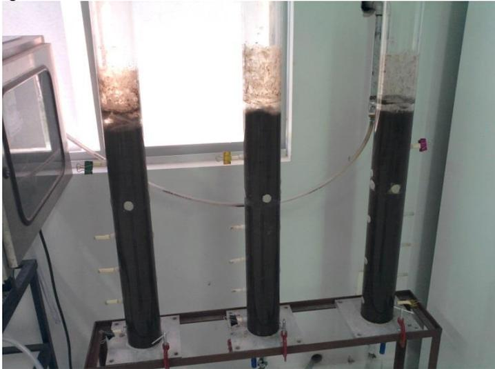
Figura 17 – Esquema dos Reatores em colunas.
