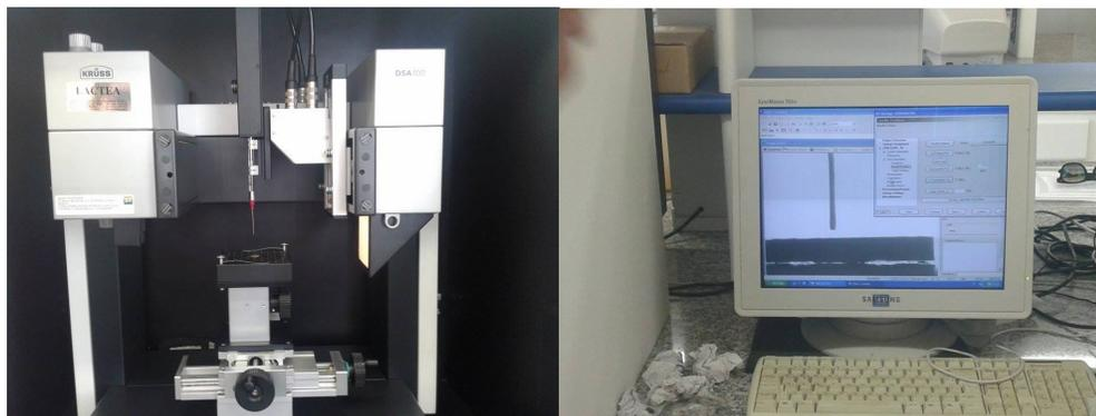
Primeiramente, colocou-se água na seringa do ganiômetro cujo diâmetro da agulha era de 1,8 mm, proporcionando uma gota de 1,5  $\mu\text{L}$  (microlitros). Em seguida, o equipamento liberou gotas de água na superfície das pastilhas embebidas em tensoativos ou KCl. Foram repetidos os mesmos processos trocando, apenas, o líquido contido na seringa, colocando-se n-parafina.
