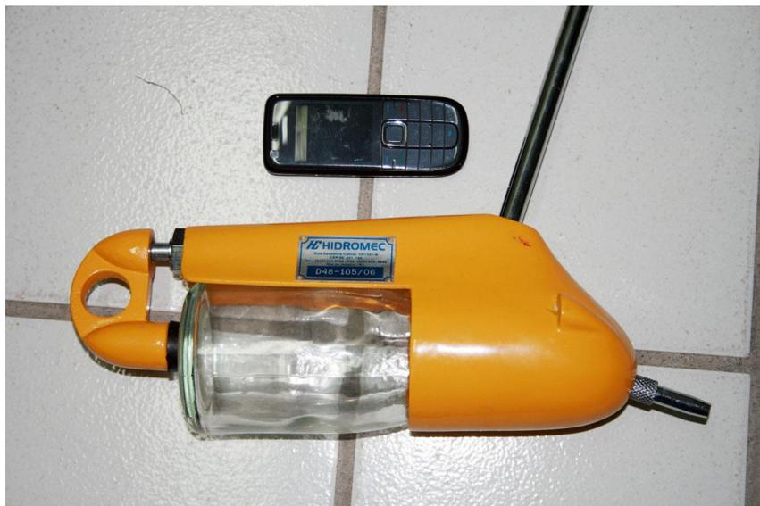
Figura 22- Amostrador US DH-48 usado para amostragem de água.
