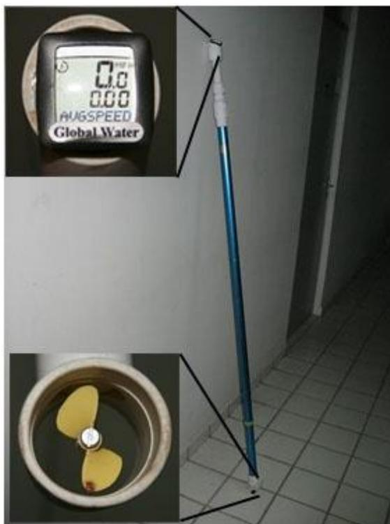
Figura 21- Micromolinetete usado para medição da vazão.
