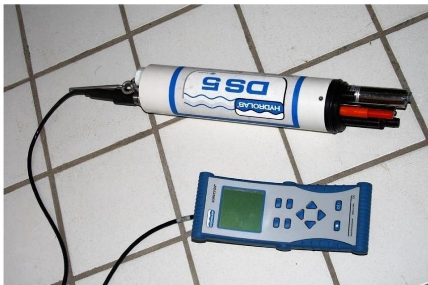
Figura 24- Sonda DS5 da Hydrolab utilizada em campo.
