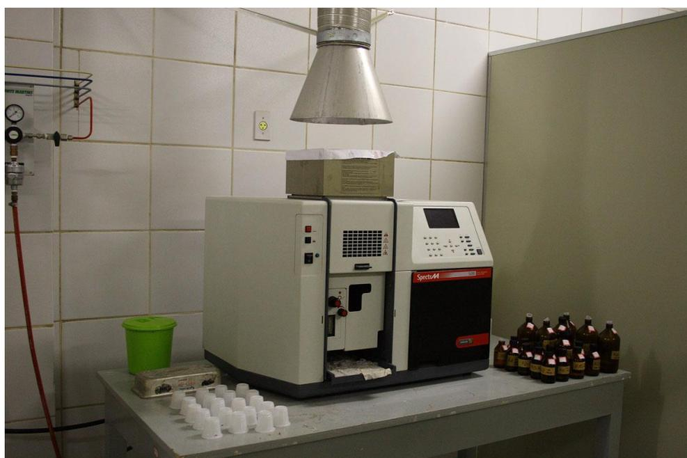
Figura 26- Espectrofotômetro de absorção atômica para medição de metais pesados.
