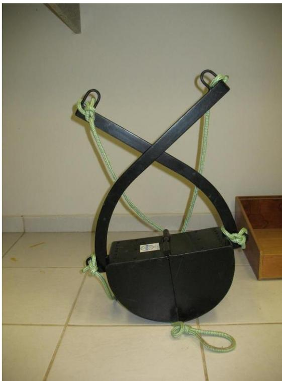
Figura 23- Amostrador utilizado para a coleta de sedimento para análise biológica.
