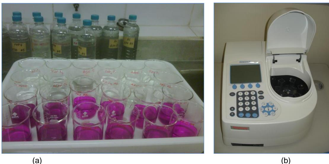
**Figura 13** - (a) Determinação da matéria orgânica natural, (b) espectrofotômetro de UV-VIS
