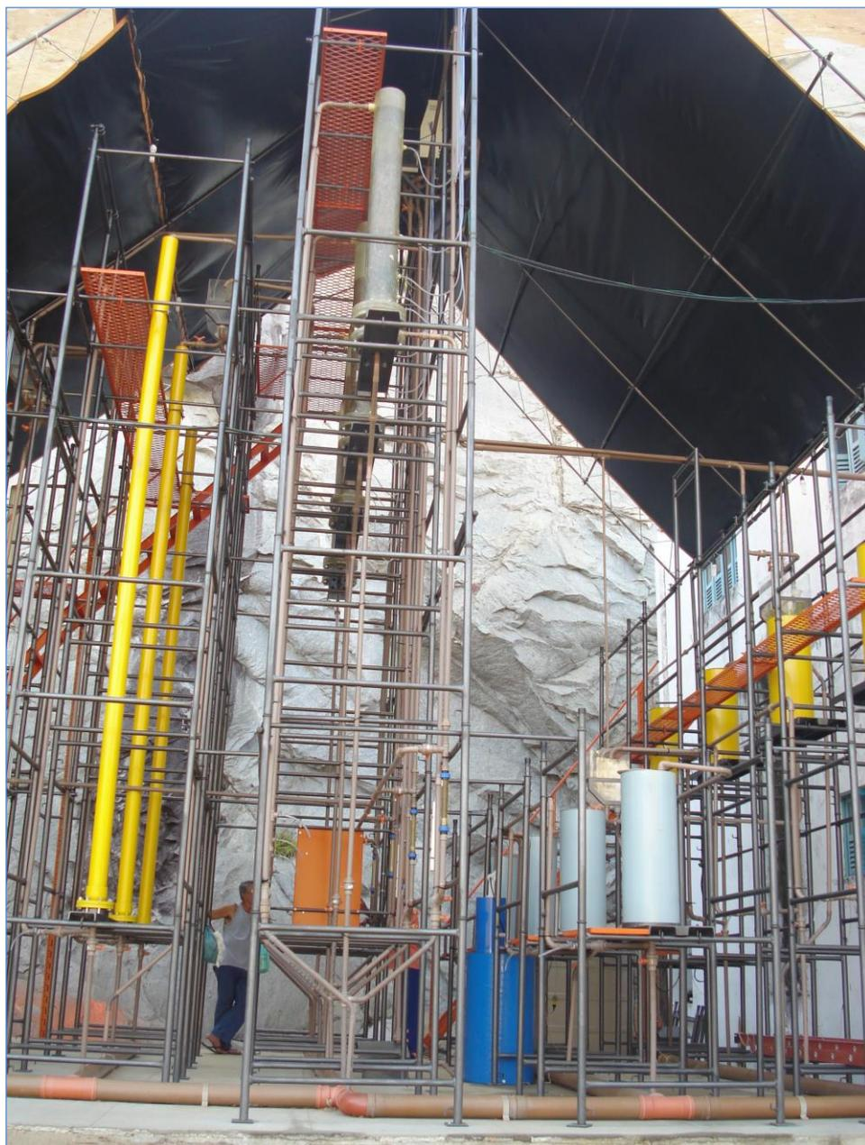
**Figura 6** - Instalação piloto dotada das etapas de préoxidação, adsorção com CAP, inter-oxidação, dupla filtração e adsorção em carvão ativado granular.
