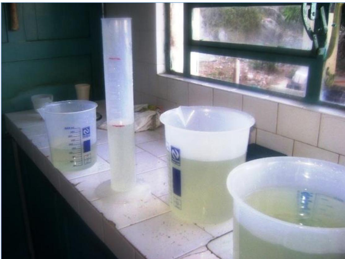
**Figura 11** - Utilização de Béqueres e proveta para homogeneização da água bruta durante os ensaios.
