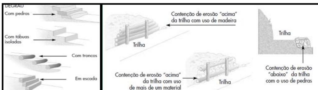
Figura 4 - **Degraus e paredes de contenção.** Fonte: Andrade W. 2003, p. 255-256
