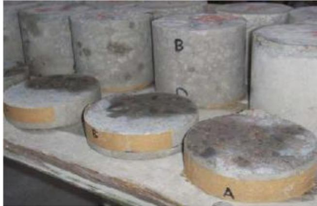
**Figura 14** - Bolacha de concreto retirada dos corpos-de-prova (Fonte:SOUZA,2007).
