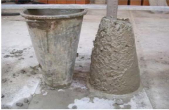
**Figura 10** - Ensaio de abatimento (Fonte: SOUZA, 2007).
