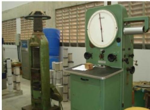
**Figura 12 -** Máquina de Ensaio Mecânico AMSLER.
