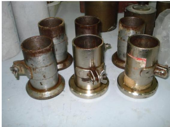
**Figura 8 - Moldes do corpo-de-prova.**
