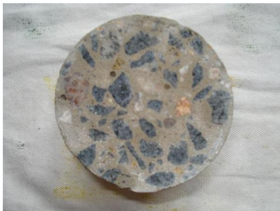
**Figura 1** - Seção transversal de um corpo-de-prova de concreto.
