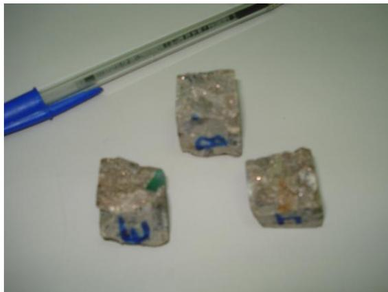
**Figura 17** - Amostras metalizadas para análise da microestrutura.
