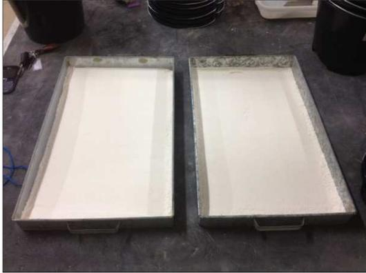
Figura 3.20 – Bandejas utilizadas para obtenção dos diâmetros de gota.
