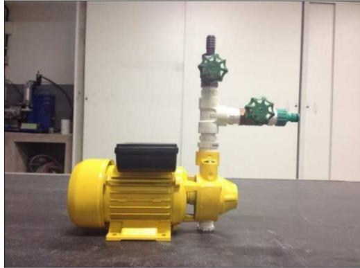
Figura 3.15 – Dispositivo para controle de vazão.
