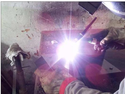
Figura 3.10 – Processo de solda TIG da chapa ao cilindro.
