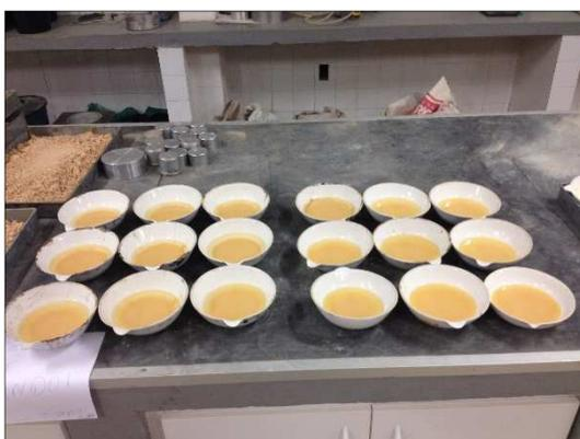
Figura 3.31 – Cápsulas antes da secagem.
