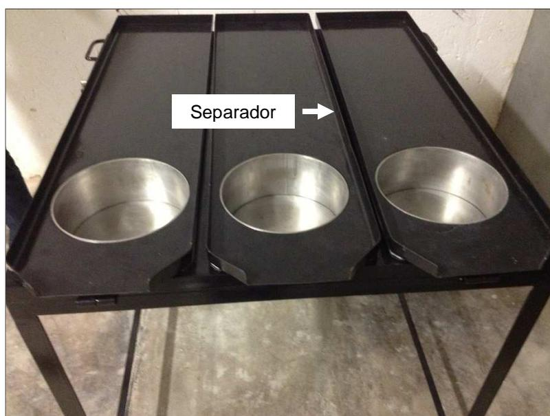
Figura 3.2 – Vista da rampa de escoamento.
