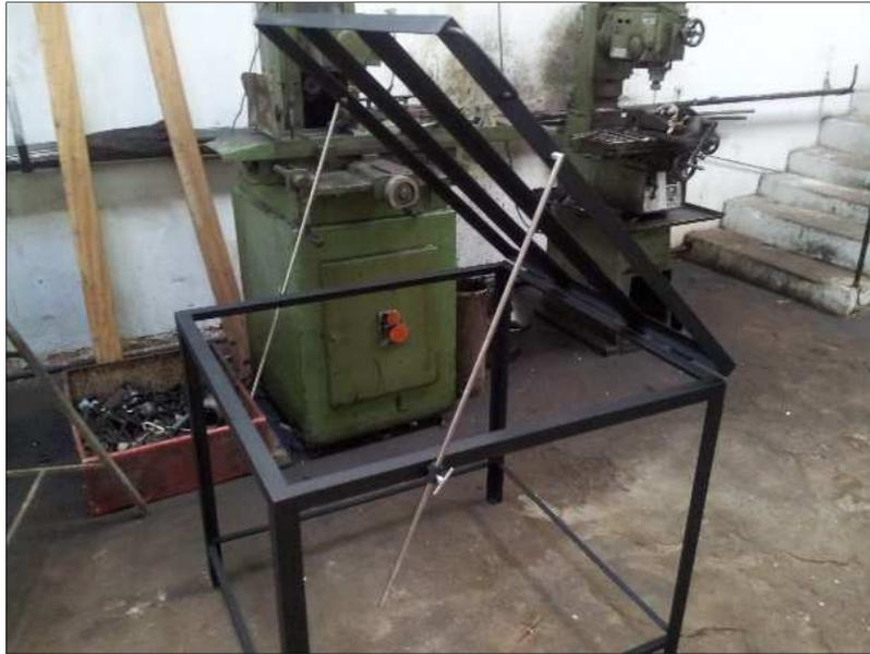
Figura 3.7 – Mesa de suporte com grelha submetida a uma inclinação qualquer.
