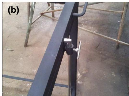
Figura 3.6 – Detalhe da conexão grelha-mesa.
