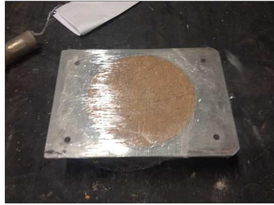
Figura 3.18 – Proteção da amostra para evitar perda de umidade.
