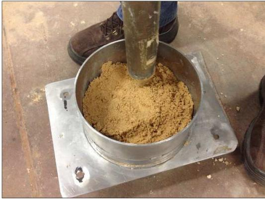
Figura 3.17 – Compactação do solo no núcleo de solo.
