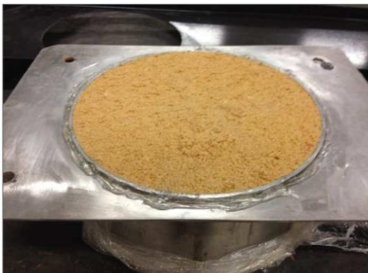
Figura 3.22 – Aplicação de silicone em gel nas bordas do recipiente.
