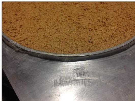
Figura 3.23 – Detalhe da aplicação de massa de calafetar.
