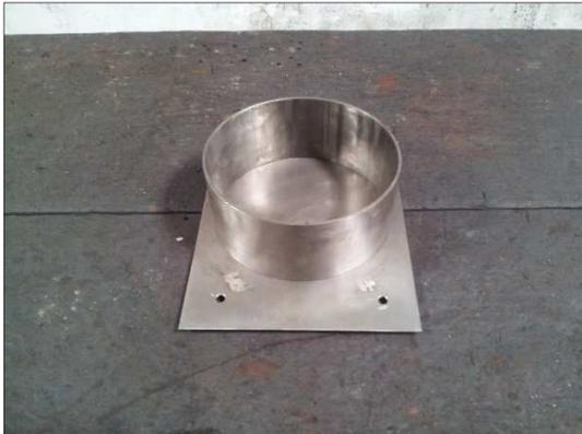
Figura 3.8 – Conformação inicial do núcleo de solo.
