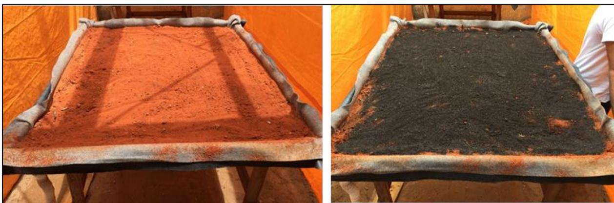
Figura 3.6: Disposição das camadas de areia barrada e do adubo.
