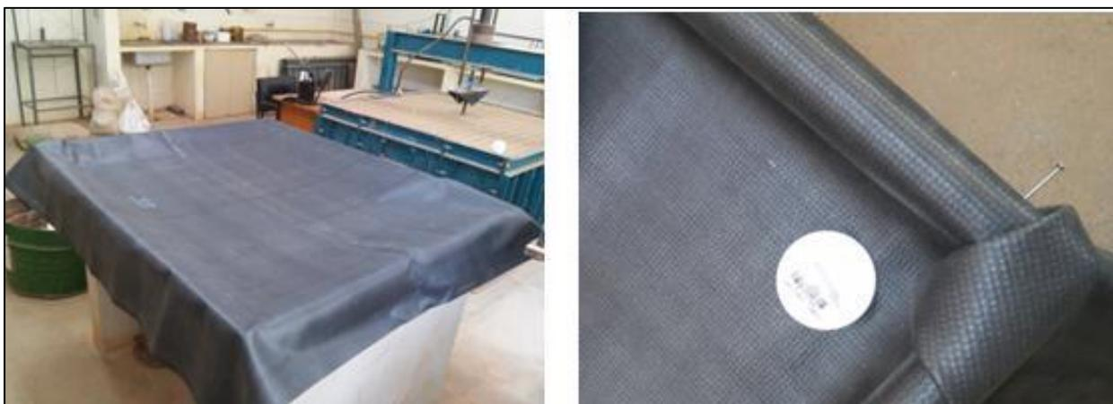
Figura 3.4: Geomembrana e válvula de drenagem instalada (Louzada, 2016).
