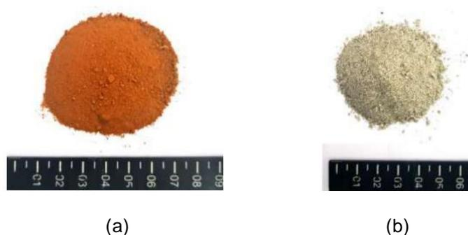
(a) Amostra de Solo, (b) Amostra do Rejeito de Granito.
