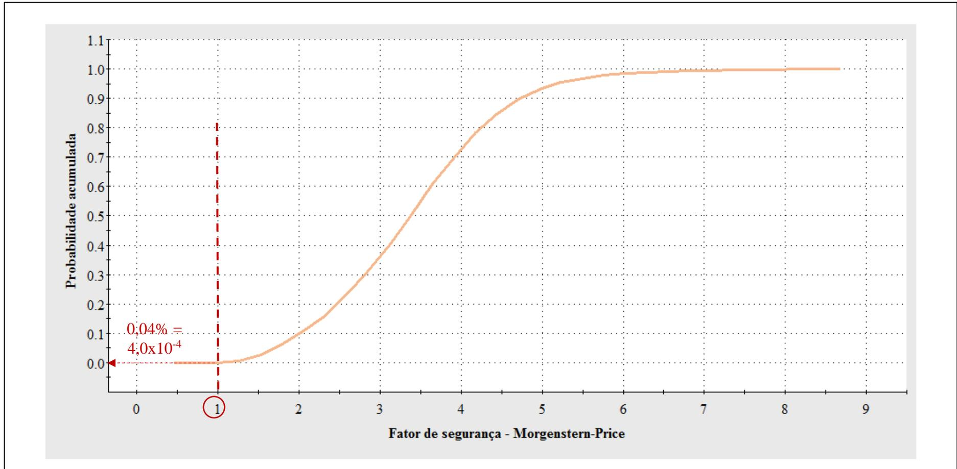
Na condição de completa saturação das duas camadas de solo para a seção 6, constata-se, como já era esperado, uma redução ainda maior nos indicadores de estabilidade desse trecho da encosta. O fator de segurança determinístico variou entre 1,22 e 1,43; o fator de segurança médio entre 0,98 e 1,46; o desvio padrão entre 0,25 e 0,30; a probabilidade de desempenho insatisfatório entre 5,56% e 49,58%; e o índice de confiabilidade entre -0,05 e 1,84.
