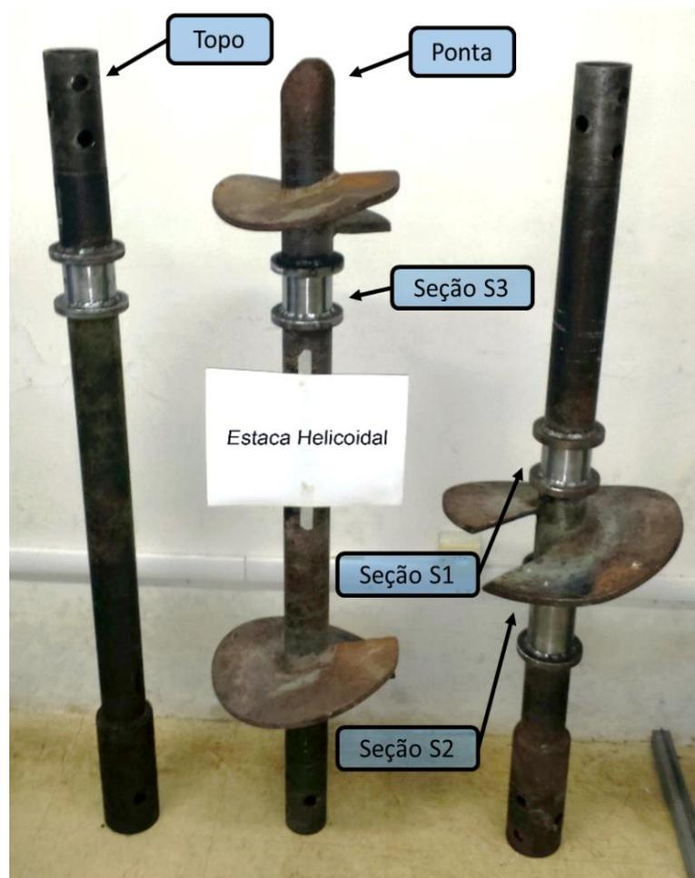
Figura 3.8 – Estaca helicoidal utilizada na pesquisa
