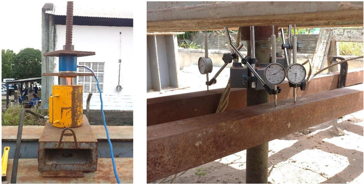
Figura 3.11 – Equipamentos utilizados nos ensaios de prova de carga à tração
