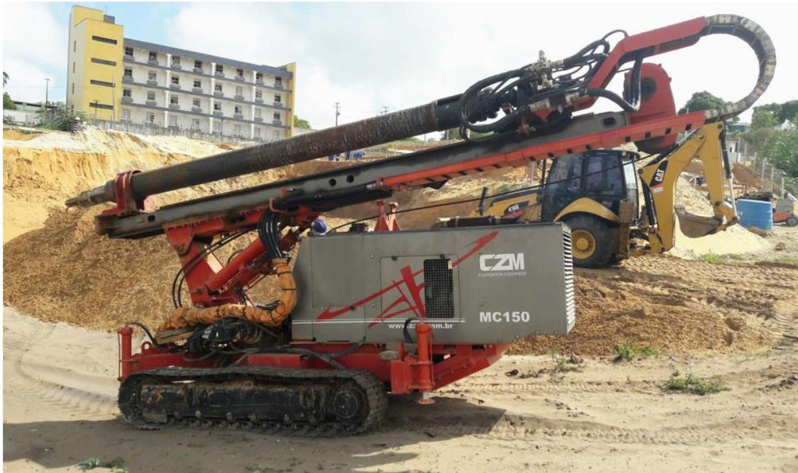
Figura 3.9 – Perfuratriz hidráulica modelo MC150 (COSTA, 2017b)
