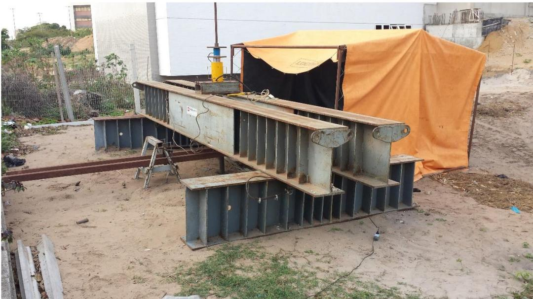
Figura 3.10 – Montagem dos ensaios de prova de carga à tração
