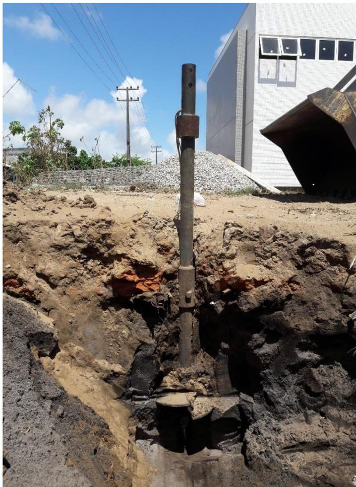
Figura 3.5 – Vista lateral de um corte após conclusão da última prova de carga (QUEIROZ, 2018)
