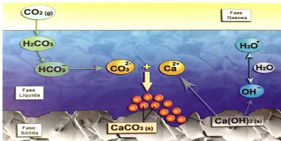
Figura 2.5 - Mecanismo de carbonatação do  $\text{Ca(OH)}_2$  (OLLIVIER; VICHOT, 2014).
