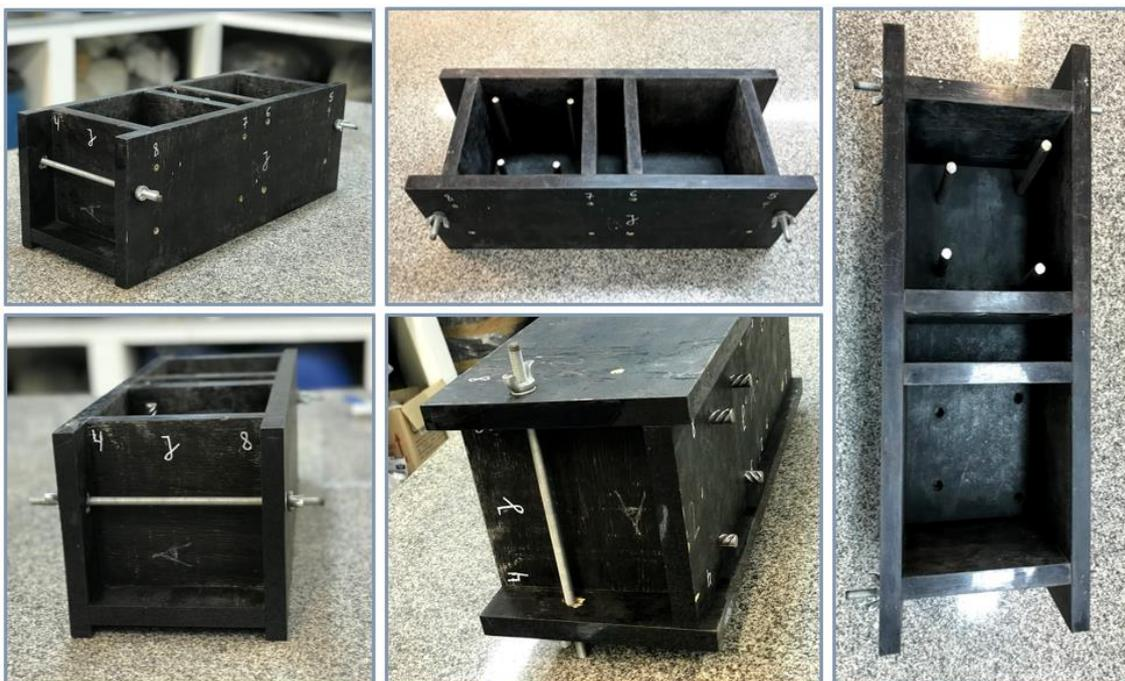
Figura 3.6 – Forma de madeira para produção dos cubos de concretos armados.
