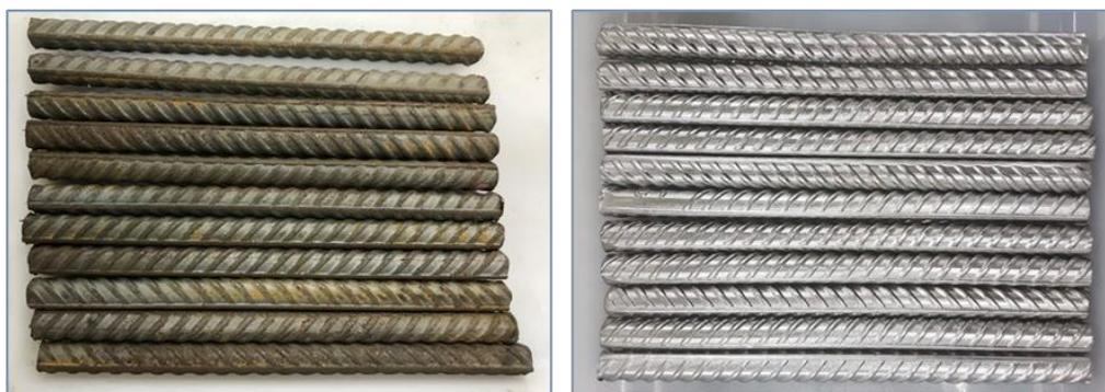
Figura 3.3 - Barras de aço antes e após o procedimento de limpeza.
