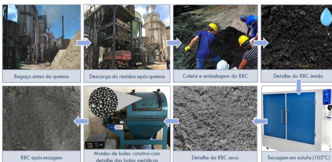
Figura 3.2- Esquema do ciclo de obtenção e beneficiamento do RBC.
