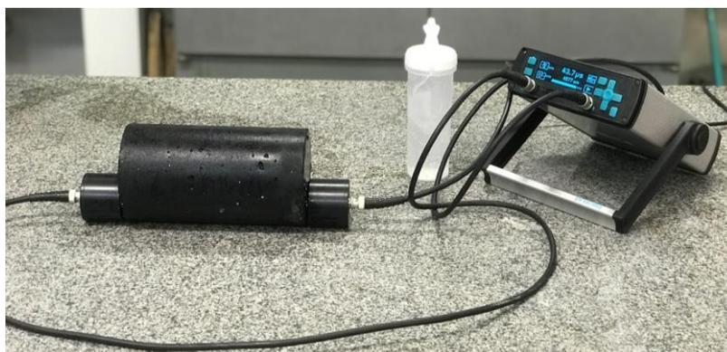
Figura 3.19 - Realização do ensaio de velocidade de pulso ultrassônico.
