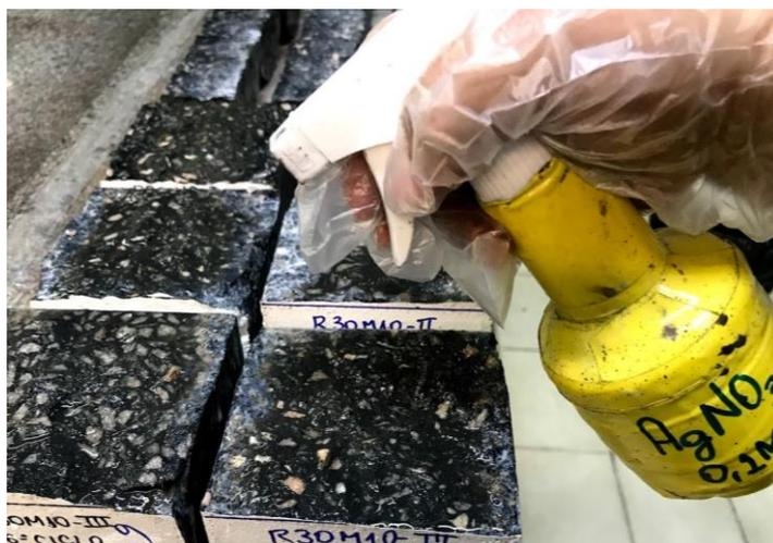
Figura 3.15 - Aplicação da solução indicadora de nitrato de prata no ensaio de profundidade de cloreto.
