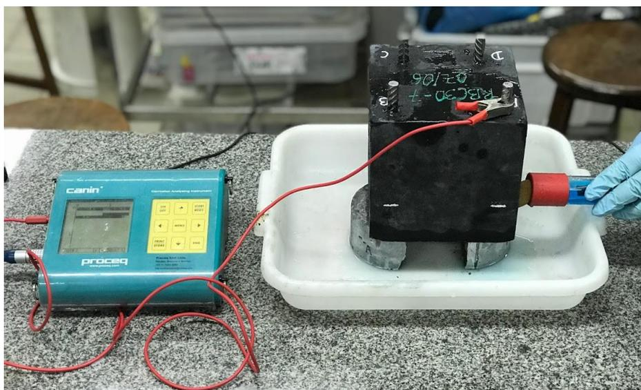
Figura 3.21 - Realização do ensaio de Potencial de corrosão.
