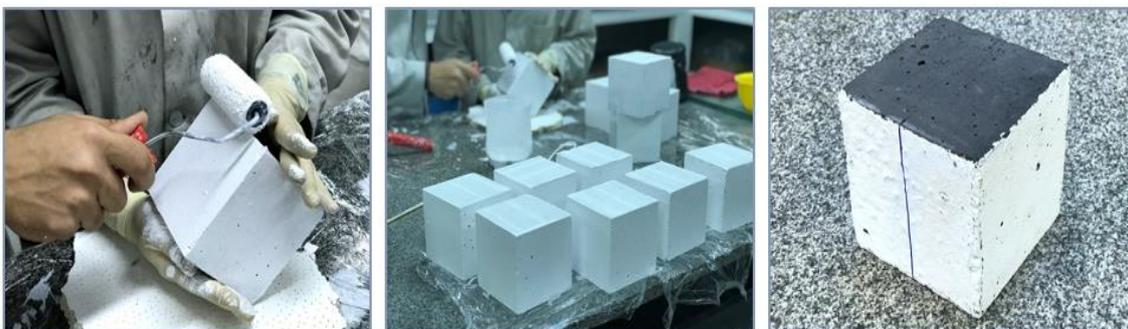
Figura 3.13 - Processo de pintura para selagem das quatro faces do cubo de concreto.
