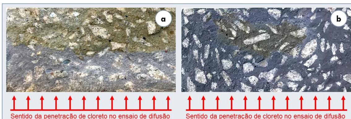
Figura 4.15 - Amostras de concreto após aspersão de nitrato de prata no ensaio de difusão de cloreto sob diferentes condições de exposição antes do ensaio: (a) sob cura submersa em água ou carbonatação e (b) só a ação conjunta de carbonatação e cloreto ou apenas cloreto.
