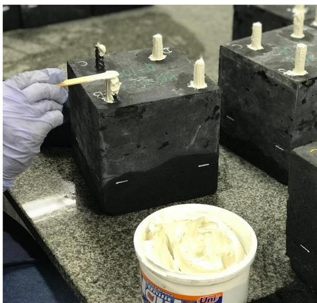
Figura 3.8 - Aplicação de graxa náutica para proteção na parte exposta das barras de aço.
