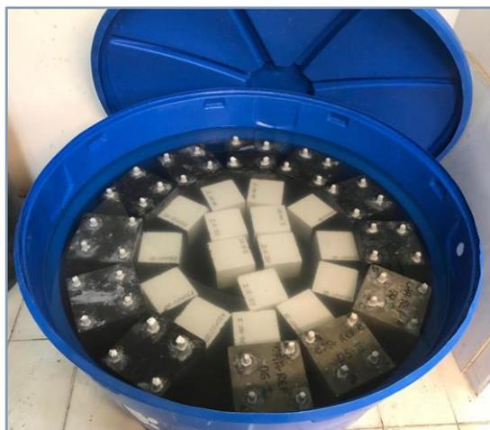
Figura 3.11 - Recipiente com os corpos de prova imersos na solução salina.
