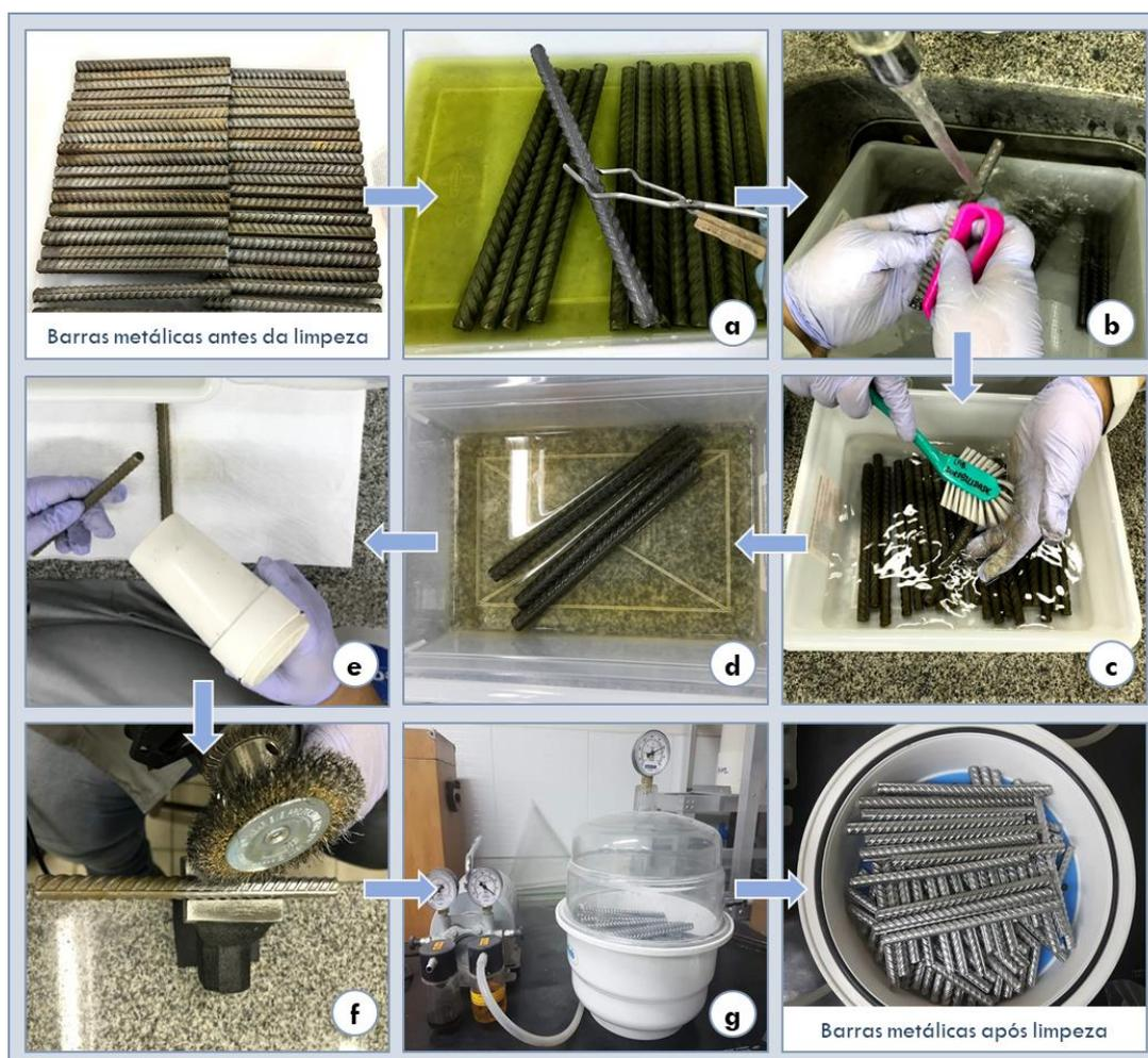
Figura 3.4 – Procedimento de limpeza das barras metálicas.
