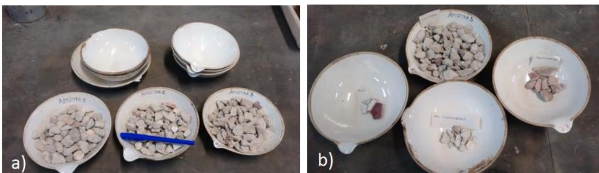
Figura 11 - Caracterização do Agregado brita 1 de RCD: a) Análise granulométrica; b) Índice de forma; c) Abrasão Los Angeles; d) Absorção e densidade
