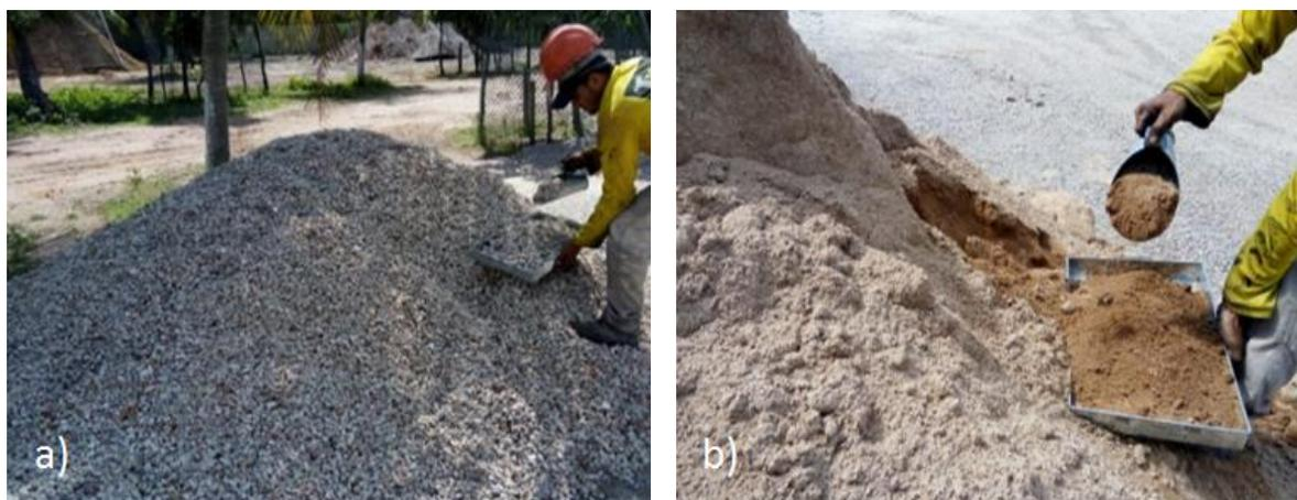
Cada um desses materiais foi acondicionado em três sacos de nylon, no qual cada saco continha, aproximadamente, 20 kg de material. Após a etapa de coleta em campo, os materiais reciclados foram cuidadosamente transportados para o IFRN, de modo a se realizar os ensaios programados para esta pesquisa. A Figura 7 ilustra os agregados reciclados usados nesta pesquisa.
