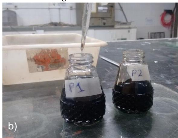
A viscosidade Saybolt-Furol foi efetuada conforme a norma DNIT-ME 004/94. Este método fixa as seguintes temperaturas de ensaio: 121°C, 135°C, 149°C, 163°C, 177°C, 204°C e 232°C. O processo consiste na contagem da medição do tempo em
