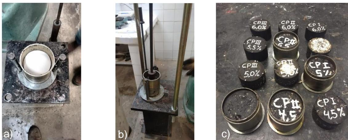
Figura 19 - Aferição das massas dos protótipos: (a) Massa seca; (b) Massa hidrostática
