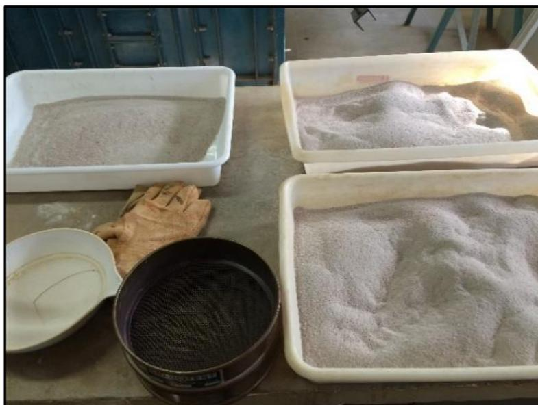
Figura 3.2 – Amostras do REFP após tratamento granulométrico. Fonte: Autor
