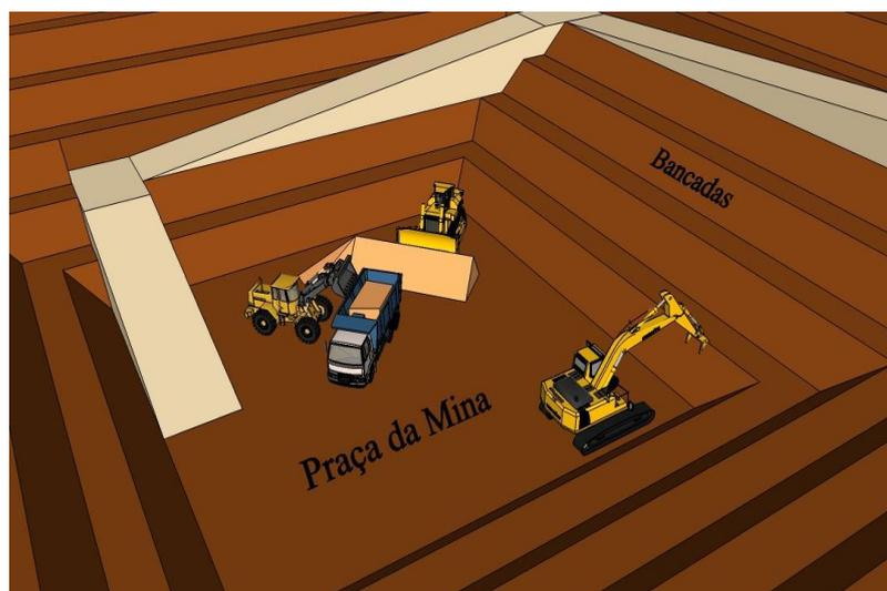
Figura 2.4 – Ilustração de uma lavra a céu aberto mecanizada. Fonte: Leonardo (2013).
