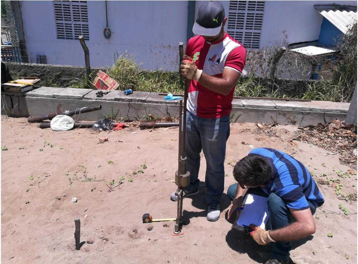
Figura 3.17 – Execução do ensaio DCP.
