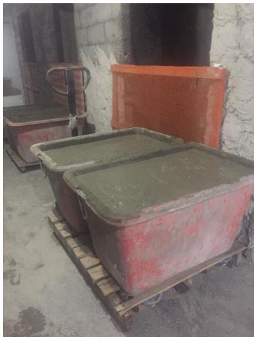
Figura 4.56 - Argamassa estabilizada no estudo de caso 3.
