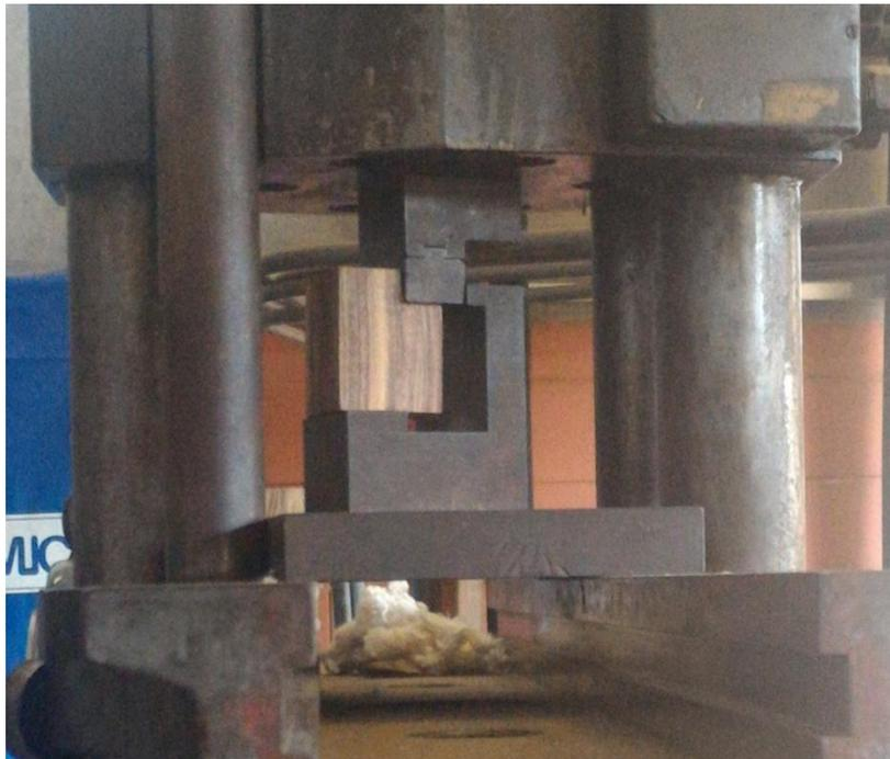
Figura 3.12 Ensaio de resistência ao cisalhamento
