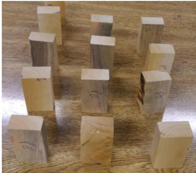
Figura 3.7 Corpos de prova para o ensaio de densidade
