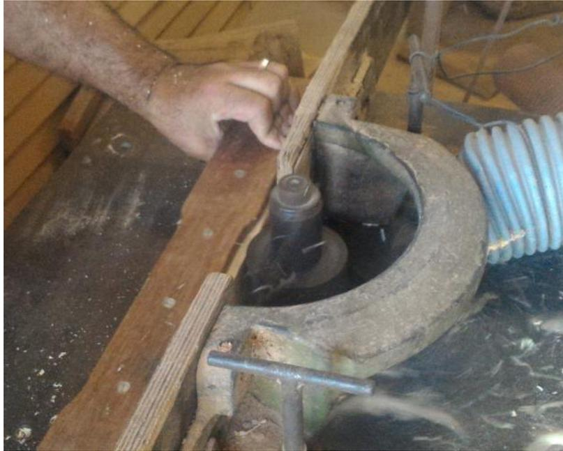
Figura 3.4 Confeção do corpo de prova para o ensaio de tração paralela às fibras.
