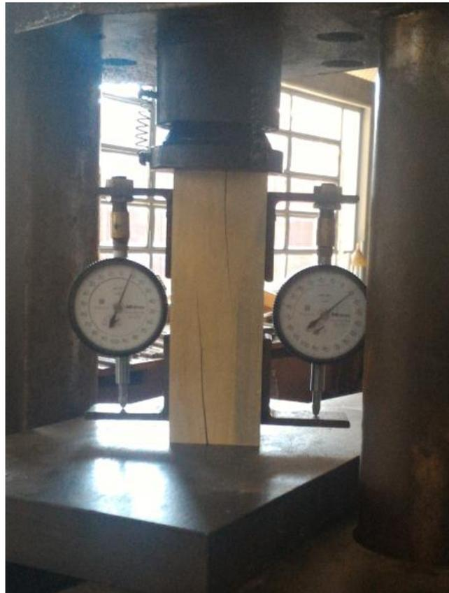
Figura 3.10 Ensaio de resistência a compressão paralela às fibras
