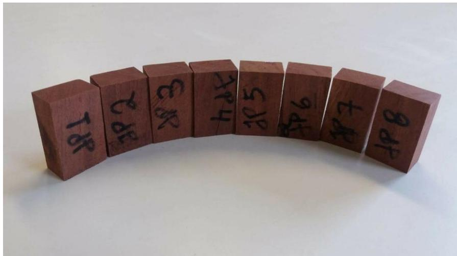
Figura 3.9 Corpos de prova para o ensaio de estabilidade dimensional
