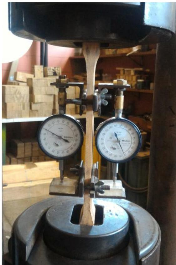
Figura 3.11 Ensaio de resistência a tração paralela às fibras
