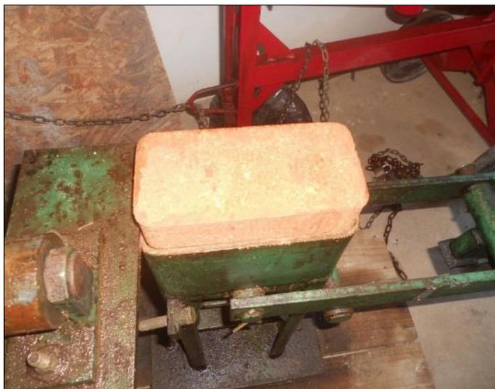
Figura 3.3 - Prensagem de tijolo maciço utilizando prensa manual.
