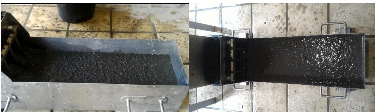
Figura 5.26 – Execução da Caixa L: RBC30 (esquerda) e PCA30 (direita).
