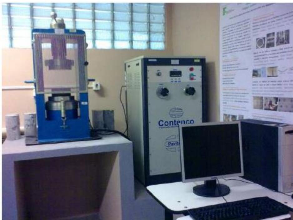
Figura 4.5 – Prensa hidráulica de rompimento
