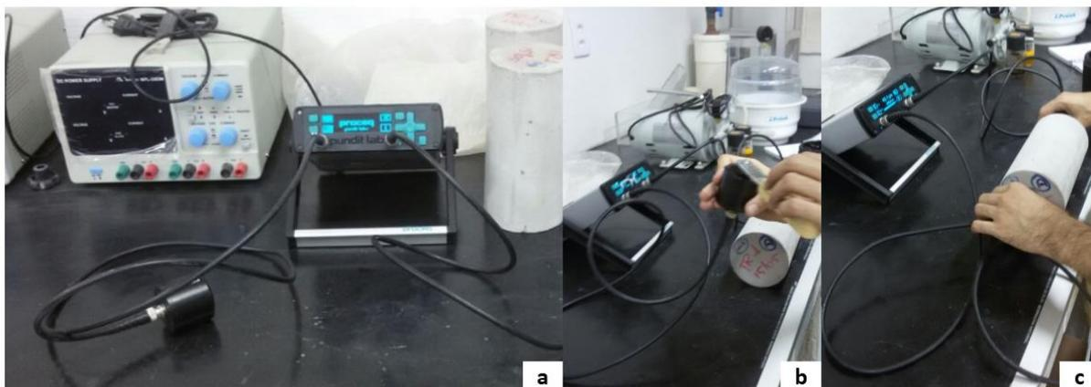
Figura 4.6 – Leitura do pulso ultrassônico: a) Equipamento; b) Transdutor com o gel; c) realização da leitura. Fonte: acervo do autor.
