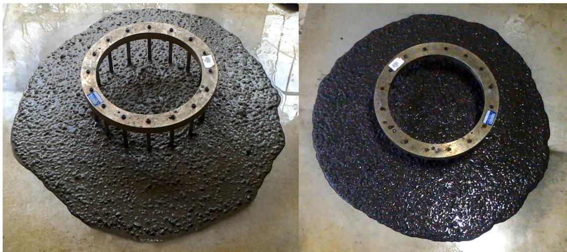
Figura 5.23 – Espalhamento com o anel J: a) TR b) R20.
