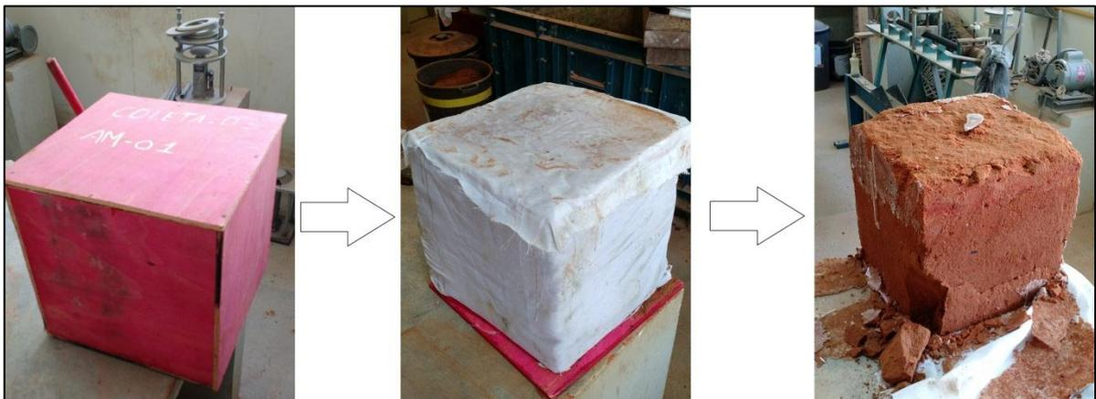
**Figura 3.4. Chegada e estado de um dos blocos indeformados utilizados.**
