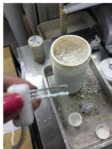
Figura 3.6 – Determinação das propriedades térmicas: (a) KD-2 Pro e câmara térmica e (b) sonda com pasta térmica e câmara térmica preenchida com isopor granulado.
