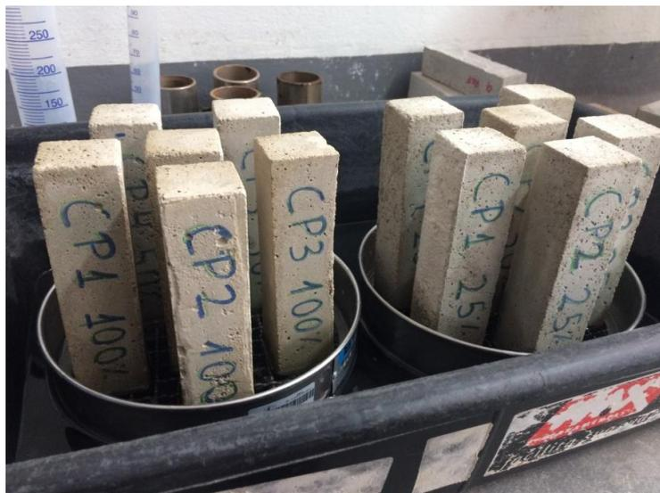
Figura 3.5 – Ensaio de absorção por capilaridade.
