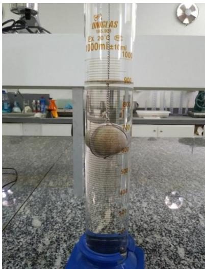
Figura 3.2 – Determinação da massa específica da vermiculita expandida.
