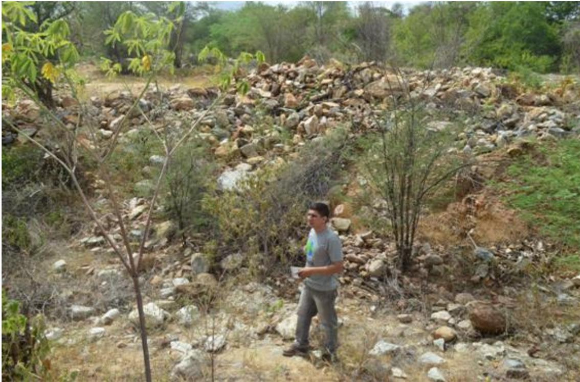
**Foto 1:** Pilhas de estéril com visíveis sinais de erosão encontrada na área de mineração de scheelita. Localizada na mina Brejuí Currais Novos-RN.
