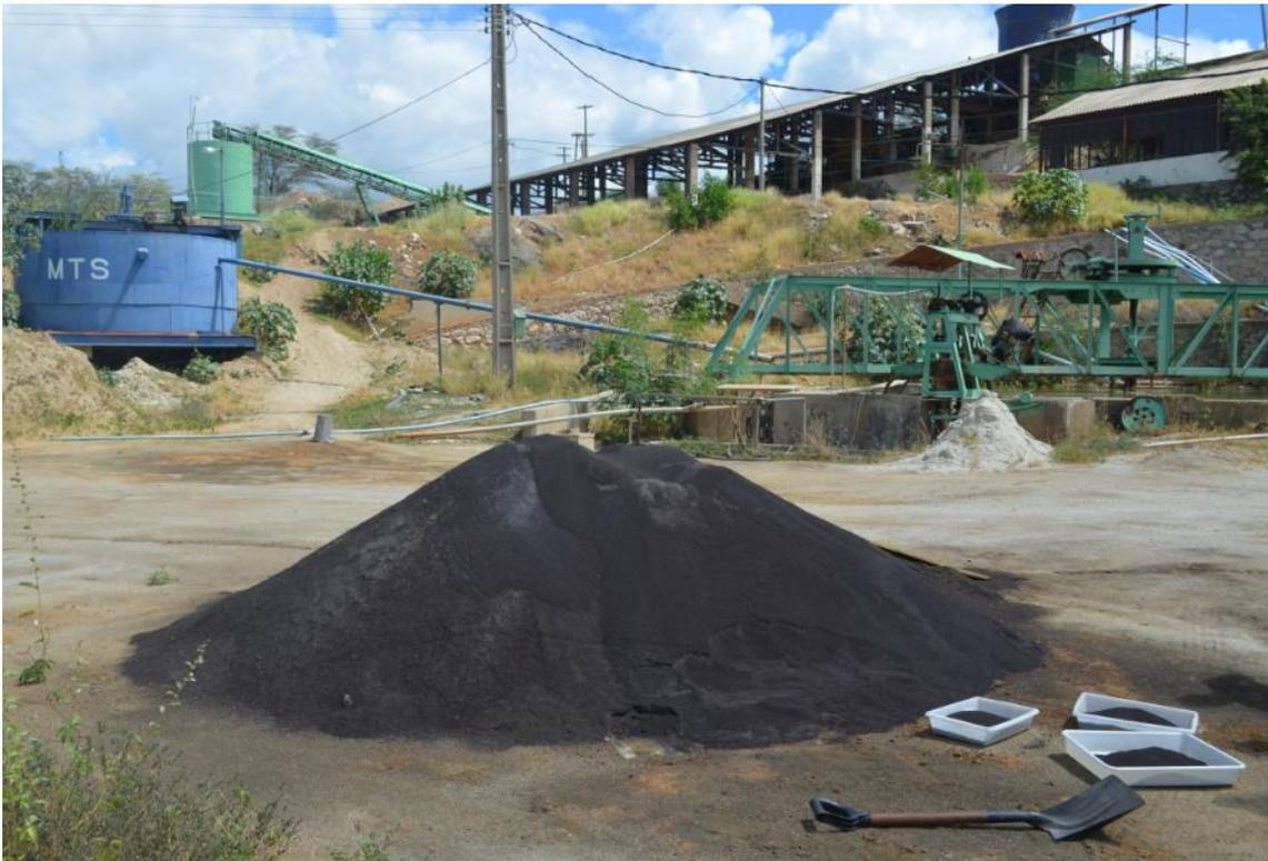
**Foto 9:** Pilha de ferroso, resíduo gerado após a utilização do eletroimã. Encontrada na mina Brejuí em Currais Novos-RN.
