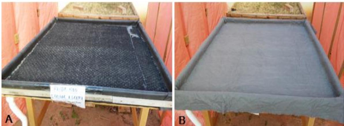
Figura 3.8 – Etapas da construção do Módulo Vegetado Geomanta (MVGA): A) Instalação do geocomposto drenante sobre a geomembrana. B) Instalação do geotêxtil sobre o geocomposto drenante.
