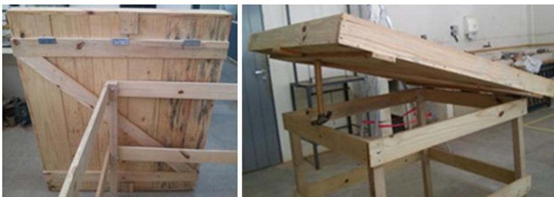
Figure 3.2 – Detalhe para possibilidade do módulo de simular coberturas íngremes e planas.
