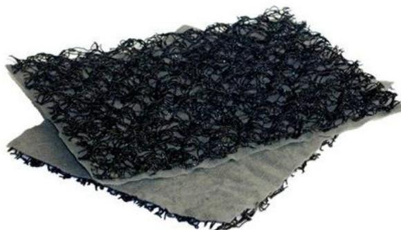
Figura 3.11 - Geocomposto drenante utilizado na pesquisa, formado por um geotêxtil não-tecido e uma geomanta.
