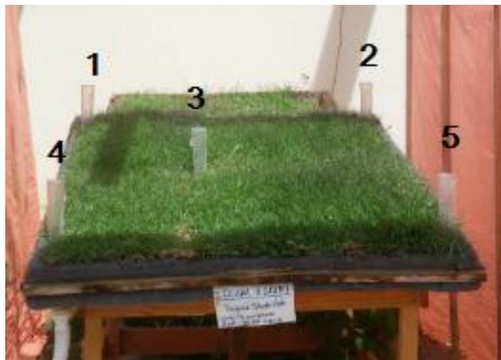
Figura 3.20 - Distribuição dos pluviômetros no momento da simulação.
