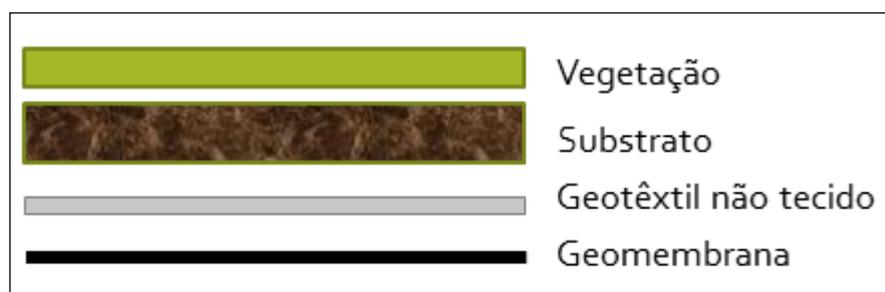
Figura 3.5 - Composição do Módulo Vegetado Geotêxtil (MVGT).
