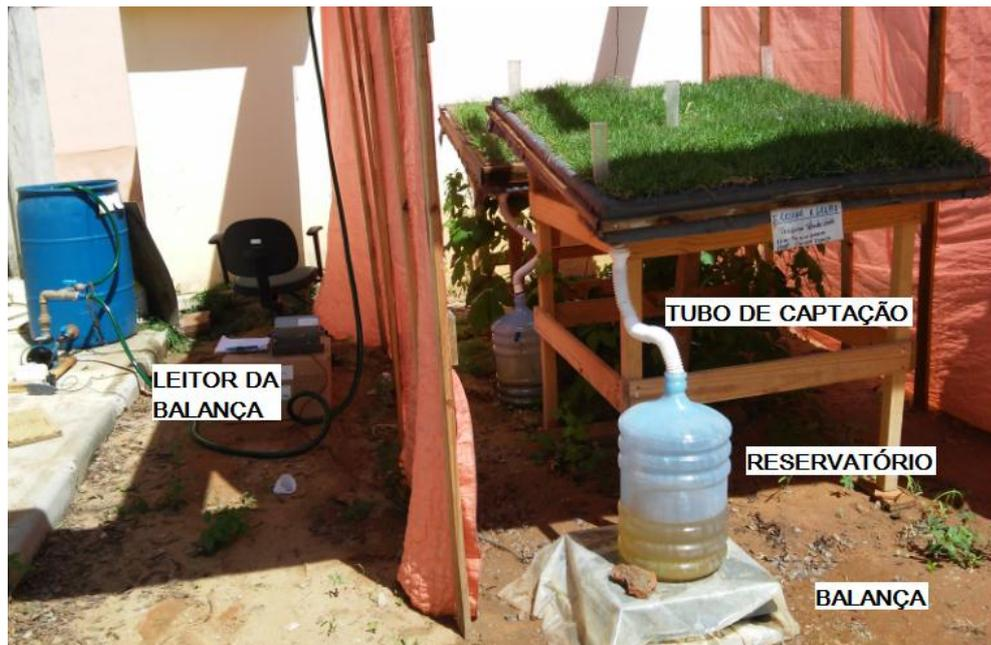
Figura 3.21 - Sistema de captação e medição do volume escoado.
