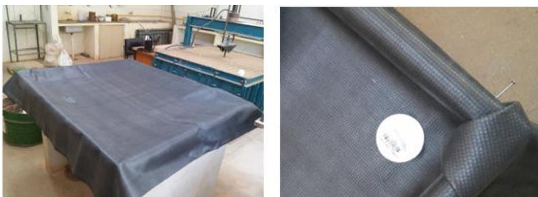
Figura 3.3 - Instalação da geomembrana e válvula de drenagem.
