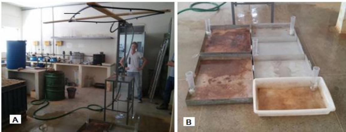
Figura 3.17 - Teste de uniformidade do simulador de chuvas: (A) detalhe para o ambiente fechado (sem influência de vento); (B) posicionamento dos pluviômetros.
