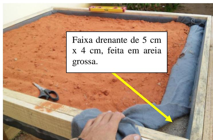
Figura 4.9 - Faixa drenante em areia grossa envolta por um geotêxtil no MVGT.
