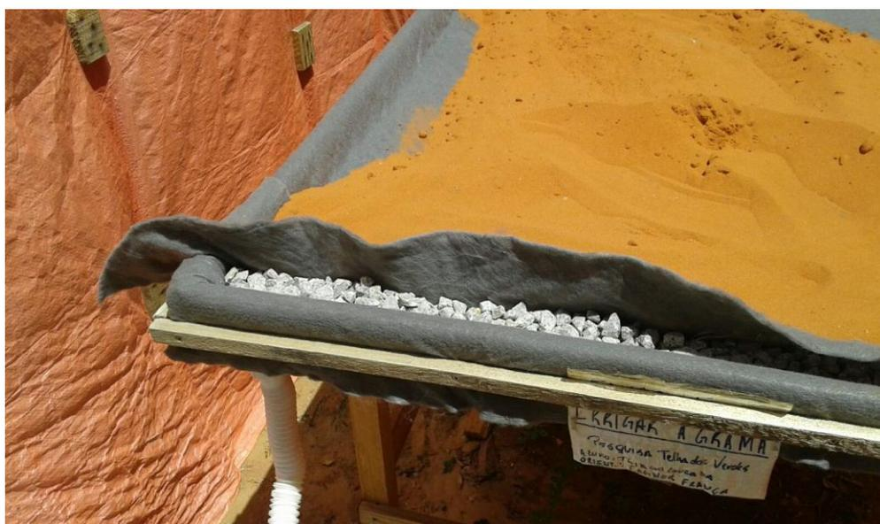
Figure 3.9 - Detalhe da faixa drenante em brita utilizada no MGA, e da fixação do geotêxtil com ripas de madeira.
