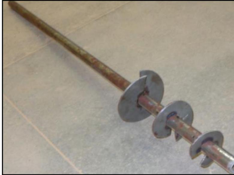
Figura 46: Protótipo da ancoragem helicoidal de múltiplas hélices confeccionado em laboratório.
