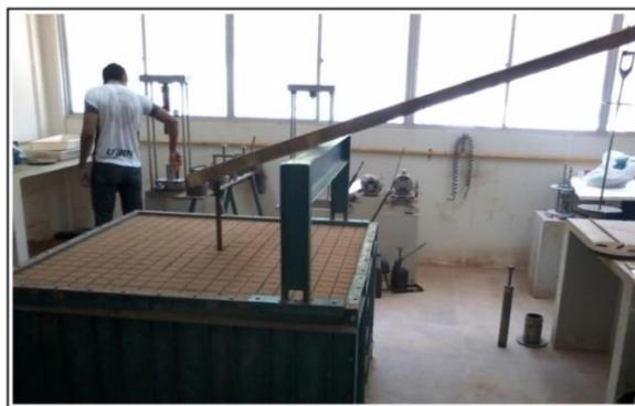
Figura 67: Sistema de alavanca desenvolvido para a realização do arrancamento total da estaca com carregamento rápido.
