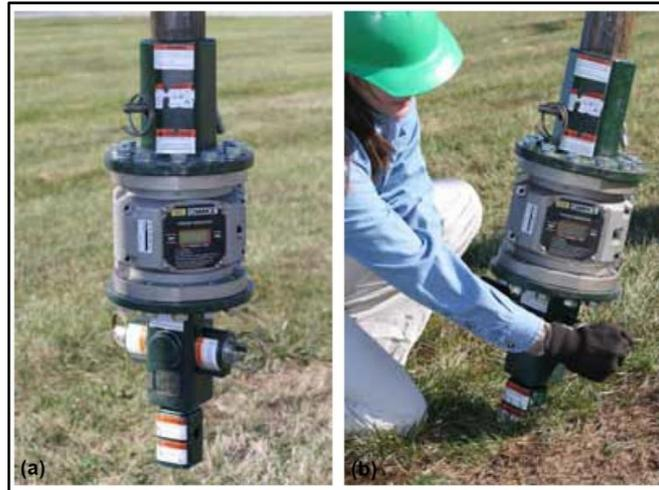
Figura 8: (a) Torquímetro e monitoramento executivo pela medição do torque (b) (A. B. Chance CO. 2014)
