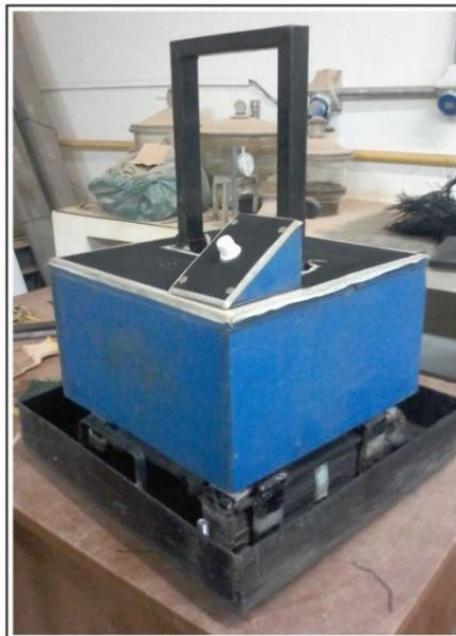
Figura 51: Compactador tipo placa vibratória.
