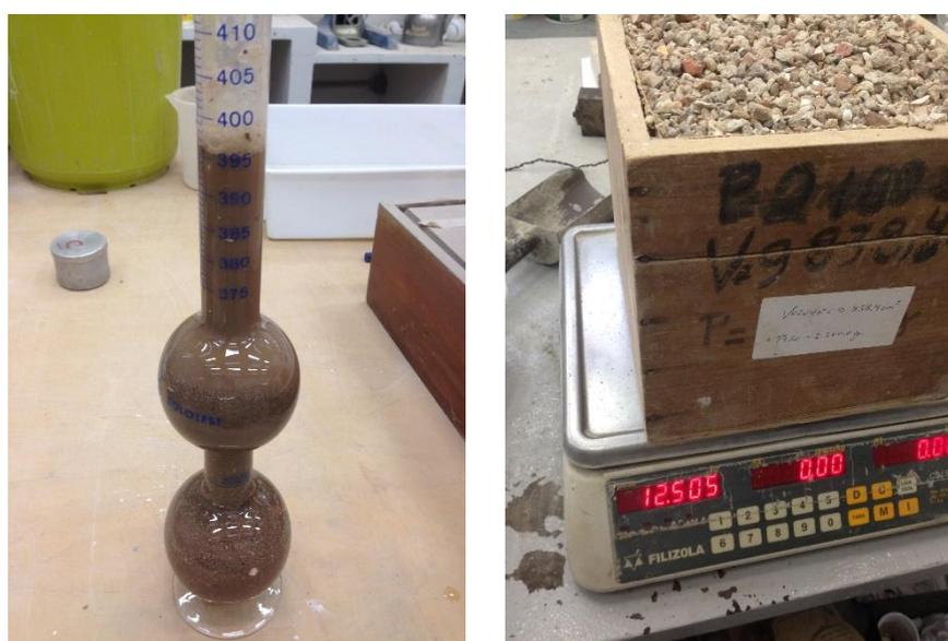
Figura 3.6 – Ensaios dos agregados: (a) Massa específica da areia reciclada; (b) Massa unitária do agregado reciclado graúdo.
