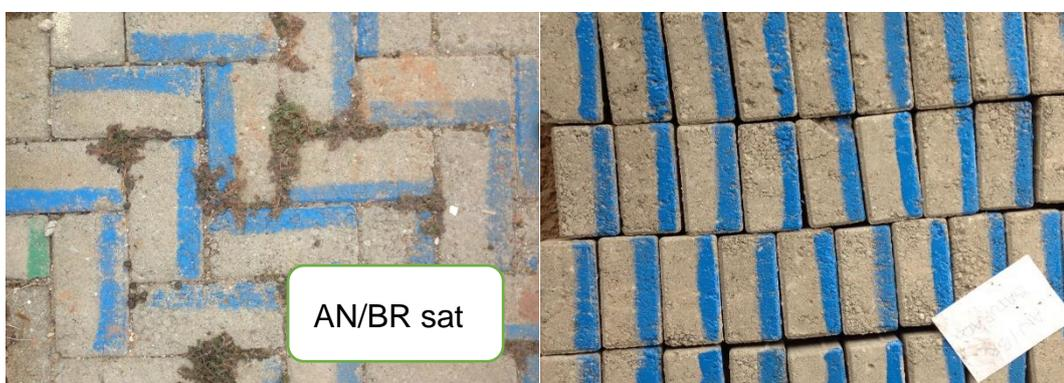
Figura 4.17 – Blocos produzidos com areia natural e brita reciclada saturada.
