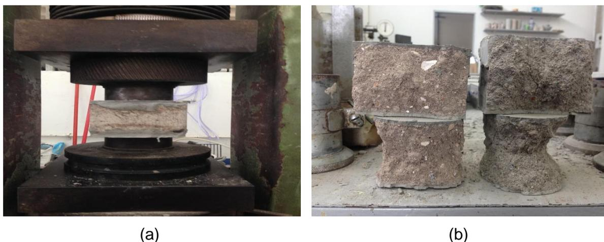
Figura 3.8 – Ensaio de resistência à compressão: (a) Equipamento com as duas placas acopladas; (b) Blocos rompidos com material reciclado e natural.
