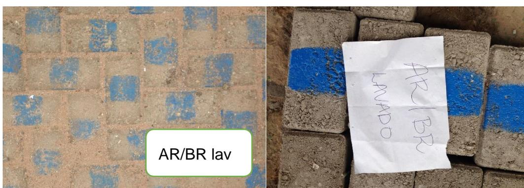
Figura 4.20 – Blocos produzidos com agregados reciclados lavados.
