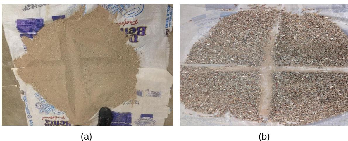
Figura 3.4 – Quarteamento: (a) Agregado reciclado miúdo; (b) Agregado reciclado graúdo.
