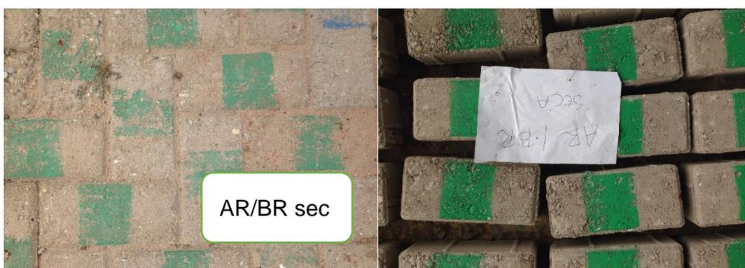
Figura 4.16 – Blocos produzidos com agregados reciclados secos.
