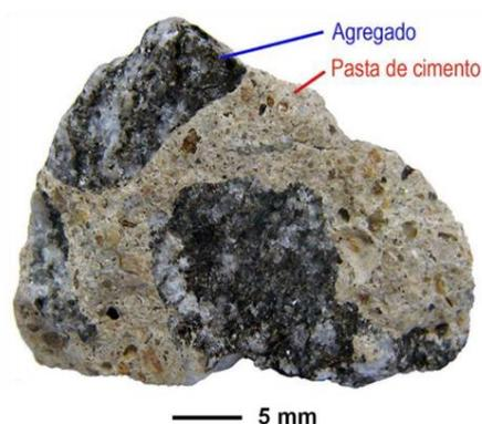
Figura 2.1 – Argamassa aderida a um grão após submetido ao processo de britagem de concreto.
