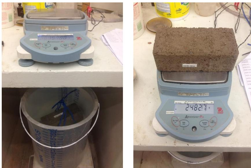
Figura 3.10 – Ensaio de absorção de água: (a) pesagem na balança hidrostática; (b) pesagem do bloco saturado.
