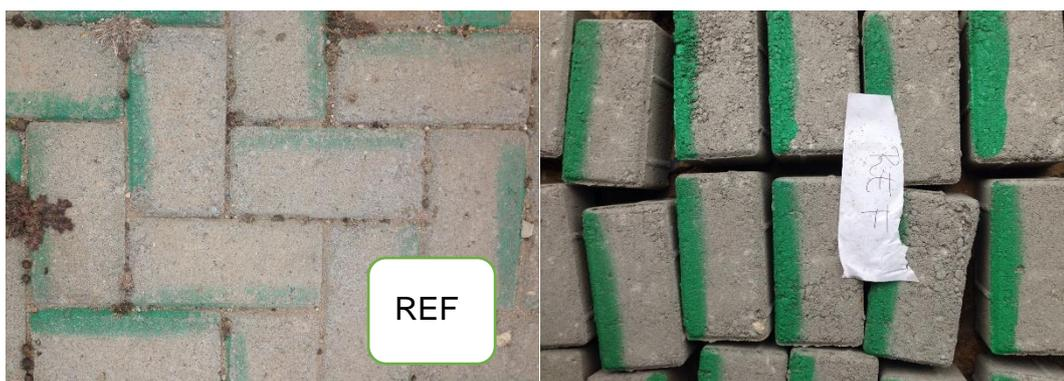
Figura 4.15 – Blocos produzidos com agregados naturais.
