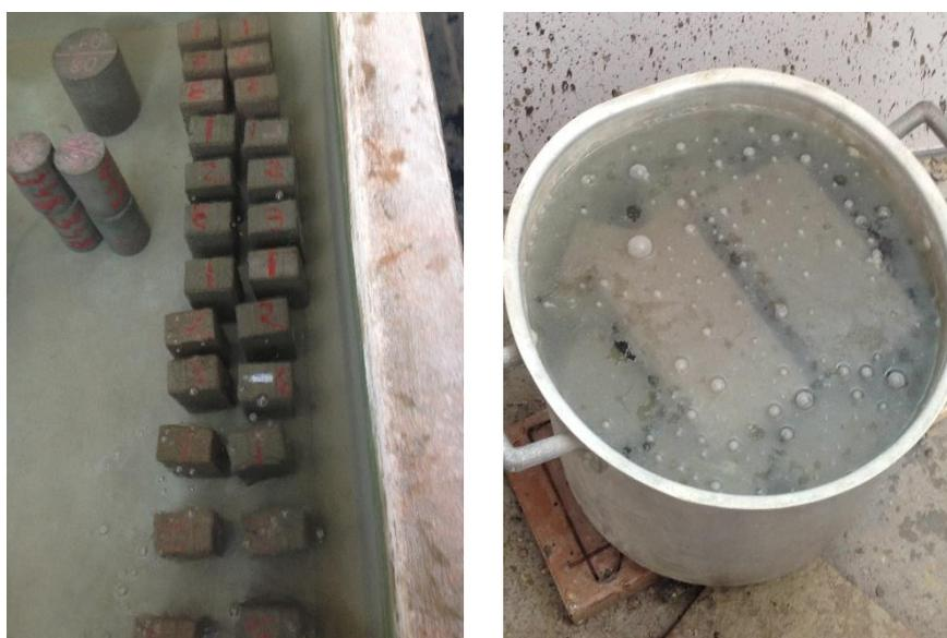
Figura 3.9 – Ensaio de absorção de água: (a) imersão segundo a NBR 9781; (b) ensaio de acordo com NBR 9778.
