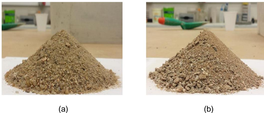
Figura 3.1 – Agregados miúdos: (a) Natural; (b) Reciclado.
