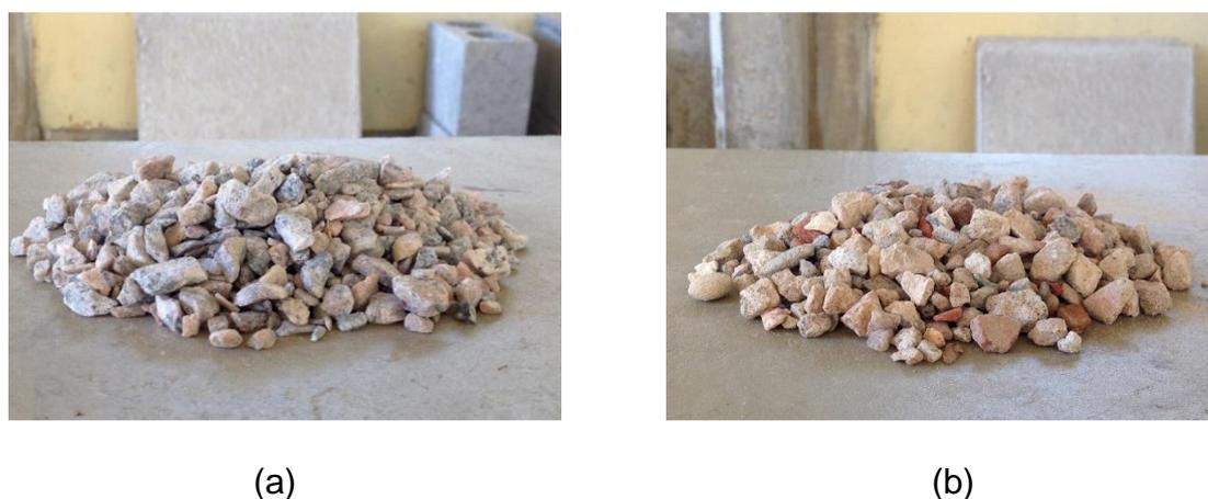
Figura 3.2 – Agregados graúdos: (a) Natural; (b) Reciclado.
