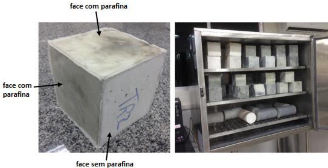
Figura 4.4 - Corpo-de-prova cúbico selado com parafina (à esquerda) e câmara de carbonatação (à direita).
