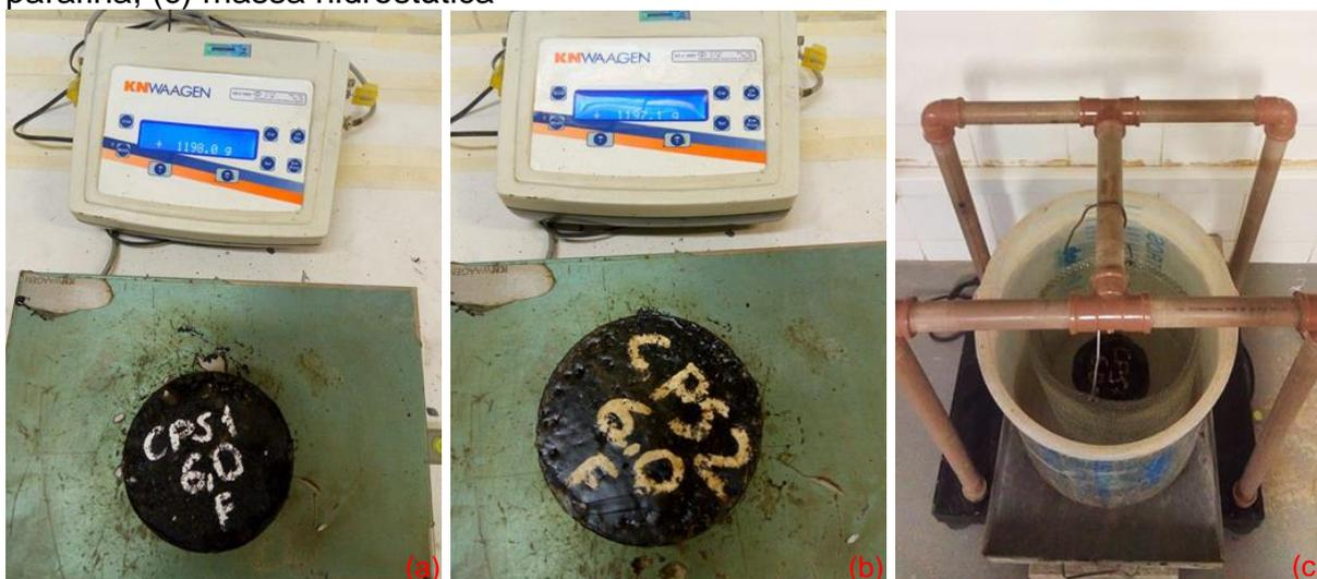
Após a aferição das massas, iniciou-se a preparação dos corpos de provas para o rompimento na prensa Marshall. Inicialmente os protótipos foram colocados em banho Maria a  $60 \pm 1^\circ \text{C}$ , como pode-se observar na Figura 3.24. Depois disso,
