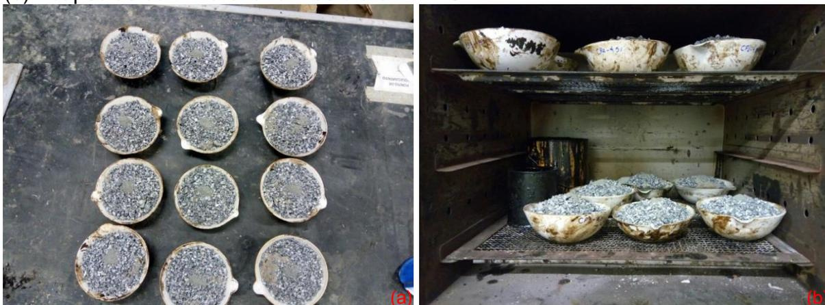
Após 24 horas, as cápsulas foram retiradas para a aferição de massa e preparação da mistura. A Figuras 3.19 e 3.20 mostram consecutivamente as etapas de aferição de massas dos componentes da mistura (agregados e ligante) e a execução da combinação dos componentes ao fogo.
