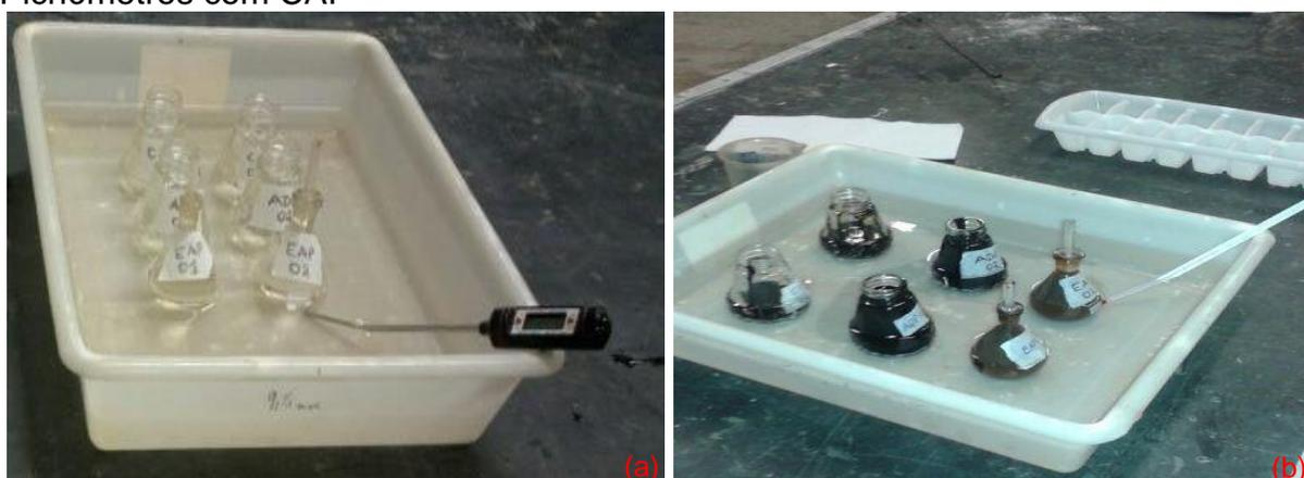
O ensaio de penetração é utilizado para verificar a consistência do CAP, pois quanto menor for a penetração da agulha na amostra, maior será a consistência da mesma. Este ensaio é normatizado pela NBR-6576/2007 e serve para a classificação do CAP a temperatura de 25° C. (BERNUCCI *et al.*, 2006).
