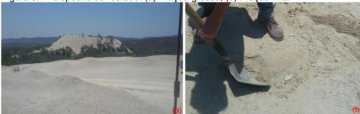
Para coletar a fração grossa nas pilhas de resíduos, abriu-se uma cavidade em torno de 30 cm para remover o material superficial existente. Isto foi realizado na base, no meio e no topo da pilha recém-formada. O resíduo foi coletado e acondicionado em sacos de nylon com capacidade para 50 kg.
