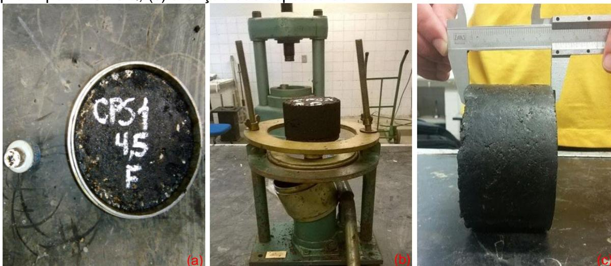
Após a etapa de aferição das espessuras, realizou-se a aferição das massas dos corpos de provas da seguinte ordem: corpo de prova seco, corpo de prova com uma camada de parafina e corpo de prova imerso em água (massa hidrostática). A Figura 3.23 mostra a sequência das aferições e equipamentos utilizados.
