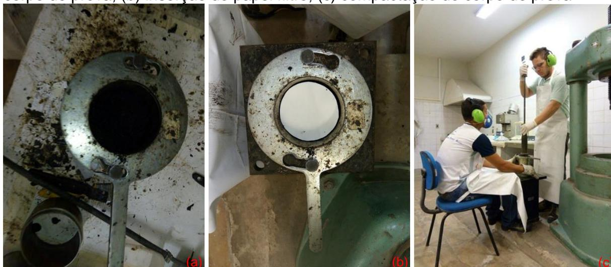
Figura 3.22 - Corpo de prova de CBUQ: (a) corpo de prova nomeado; (b) extração do protótipo de CBUQ; (c) aferição das espessuras
