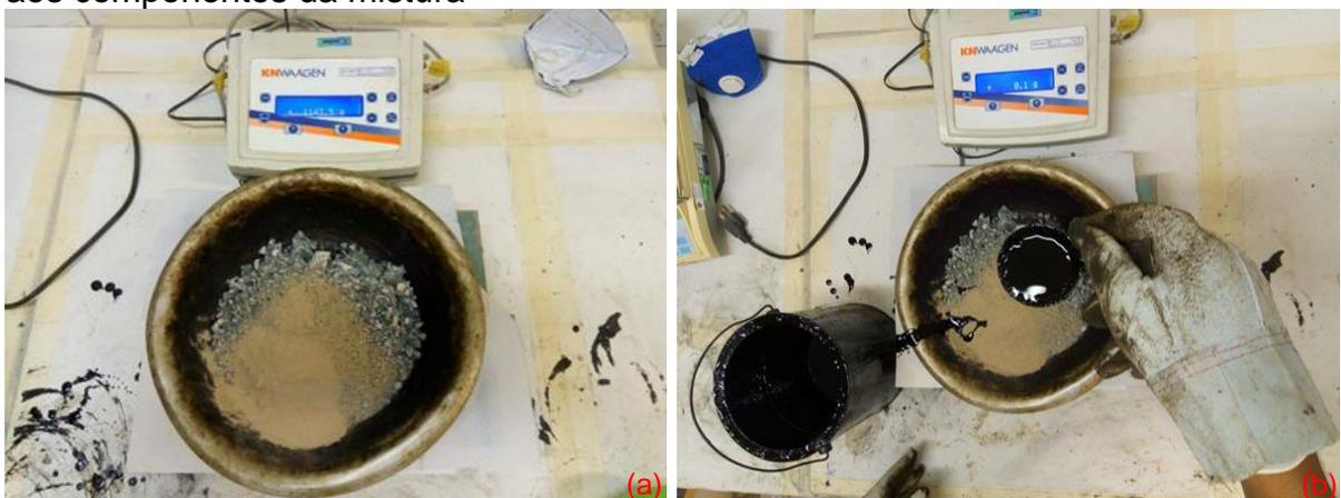
Figura 3.20 - Realização mistura betuminosa: (a) agregados e ligante ao fogo; (b) mistura betuminosa completa
