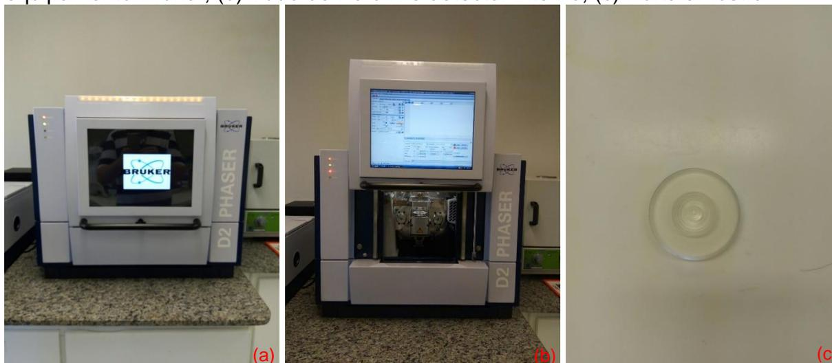
As amostras utilizadas para a realização deste ensaio, foram colocadas no centro de um porta amostra de acrílico (Figura 3.7c) e posteriormente levada para o equipamento onde foi submetida a incidência de Raio-X para a varredura
