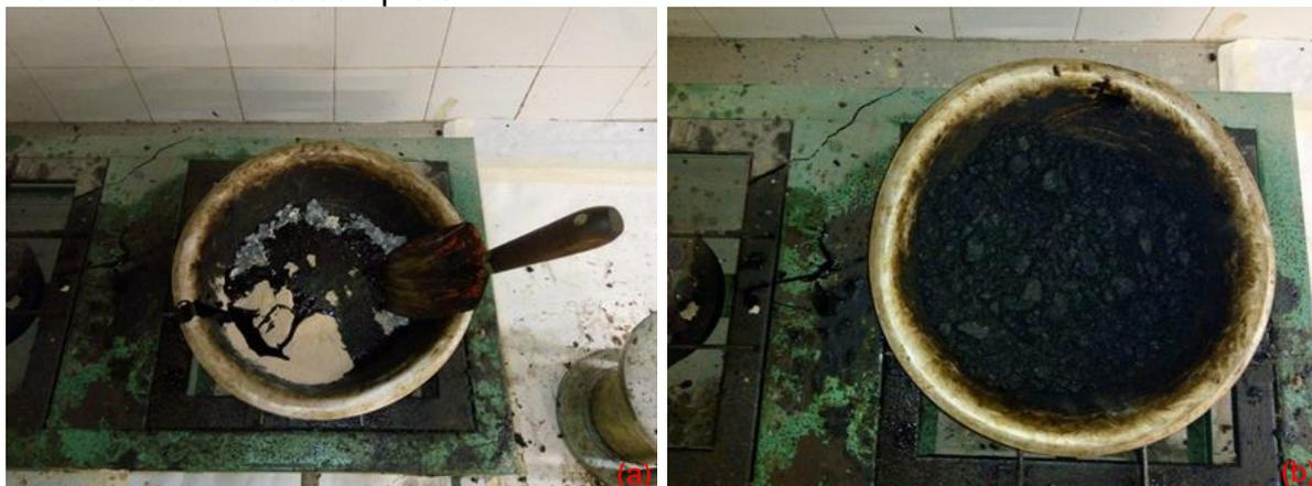
Ao término das etapas de aferição de massa e a realização da mistura betuminosa ao fogo, iniciou-se a moldagem dos corpos de provas. As Figuras 3.21 e 3.22, demonstram os passos de moldagem e compactação, e posterior extração e aferição das espessuras dos copos de prova de concreto asfáltico.
