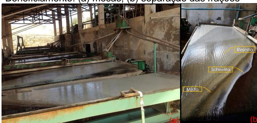
Depois do helicónde, o misto é direcionado às mesas de concentração em cotas topográficas inferiores às cotas das mesas vibratórias iniciais. A separação da scheelita ocorre novamente e o misto retorna ao helicónde para ser encaminhado novamente as mesas de concentração e minimizar o desperdício de scheelita junto ao resíduo.
