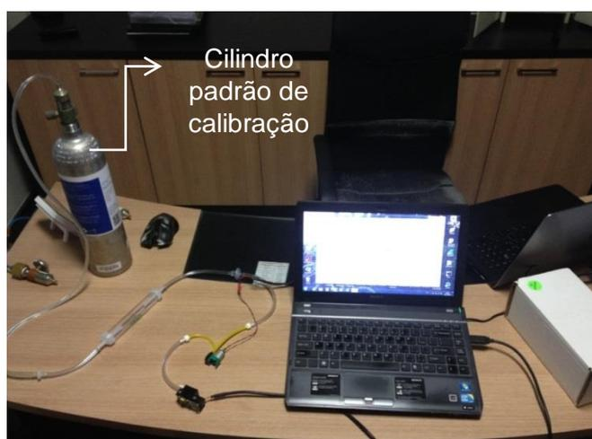
Figura 78: Conexão do sensor ao cilindro padrão de calibração: Fonte: Autor (2015).
