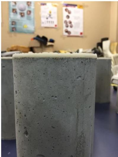
Figura 114: Corpo de prova com o topo selado com cera de parafina - Fonte: Autor (2015).
