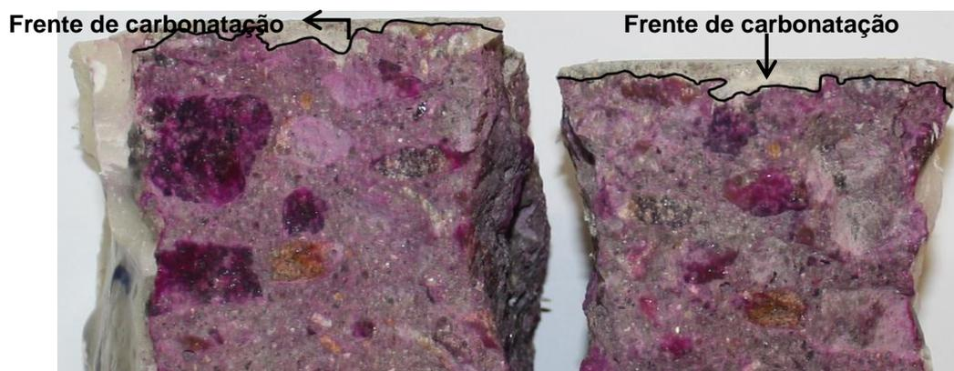
Figura 126: Exemplo de carbonatação acelerada em 2 faces de um corpo de prova aos 28 dias de exposição- Fonte: Autor (2015).
