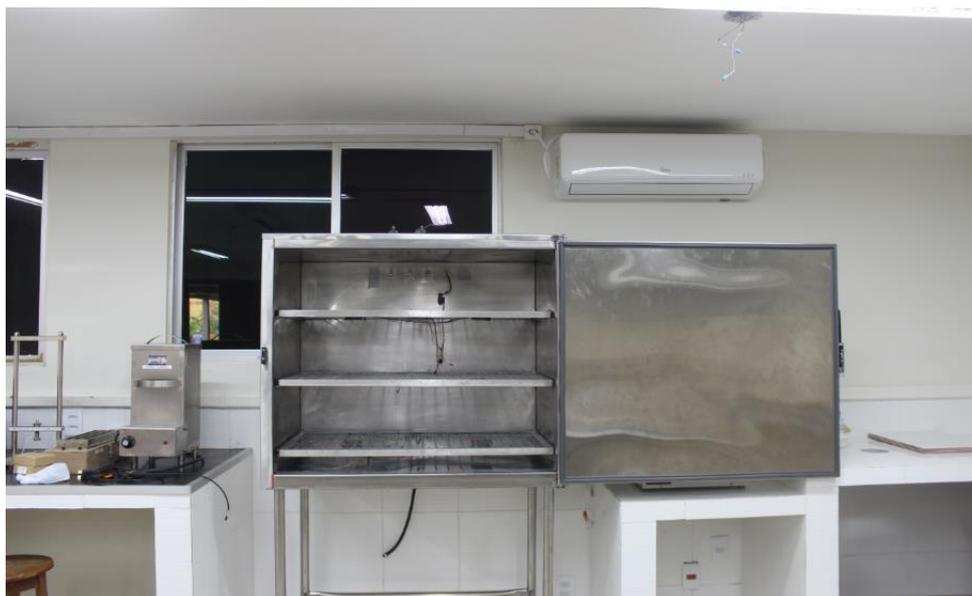
Figura 69: Vista da câmara de carbonatação aberta - Fonte: Autor (2015).
