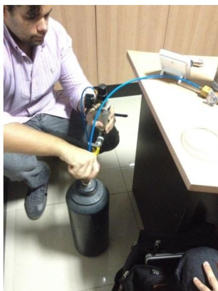
Figura 80: Conexão do sensor ao cilindro de nitrogênio: Fonte: Autor (2015).
