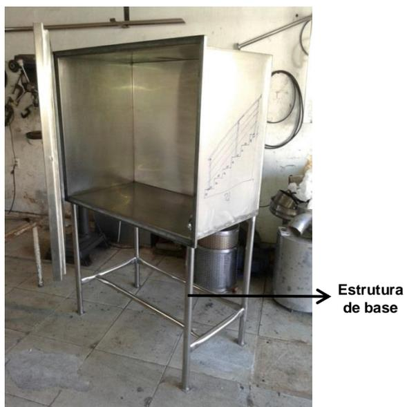
Figura 50: Ilustração da instalação da estrutura de base da câmara de carbonatação
