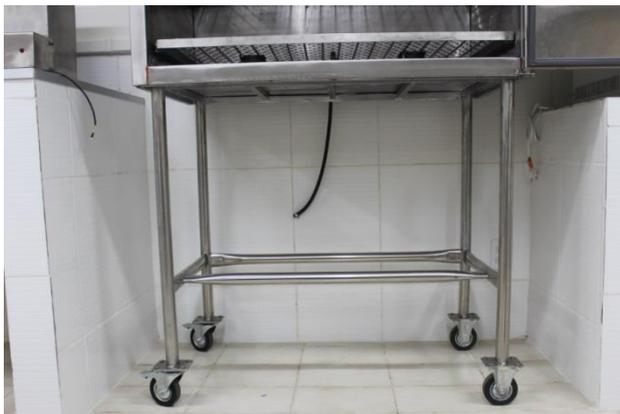
Figura 70: Base de suporte e rodízios da câmara de carbonatação - Fonte: Autor (2015).
