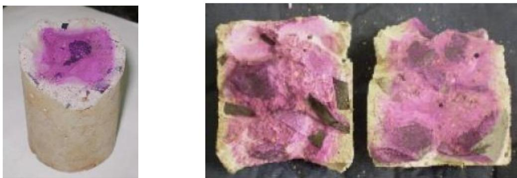
Figura 16: Planos de ruptura: (a) primeiro plano; (b) segundo plano. - Fonte:
