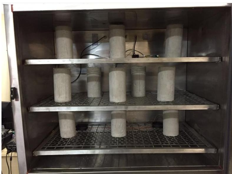
Figura 120: Inserção dos corpos de prova na câmara de carbonatação acelerada -
