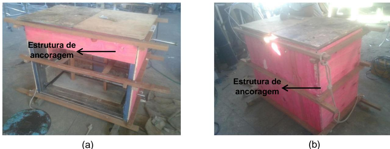
Figura 52: Ancoragem para suporte de pressão: (a) ancoragem do gabinete interno; (b) ancoragem do invólucro - Fonte: Autor (2015).
