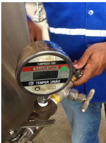
Figura 63: Manômetro para aferição de pressão - Fonte: Autor (2015).
