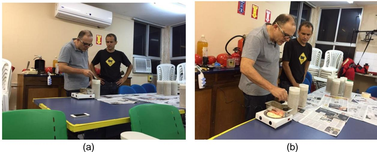
Figura 112 a e b: Aplicação de cera de parafina com pincel na base e no topo dos corpos de prova - Fonte: Autor (2015).
