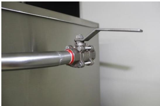
Figura 57: Válvula tipo esférica com  $\frac{1}{4}$  de giro - Fonte: Autor (2015).
