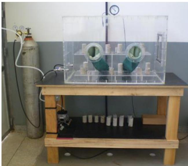
Figura 11: Câmara de carbonatação acelerada - Fonte: Salomão e Silva (2008).
