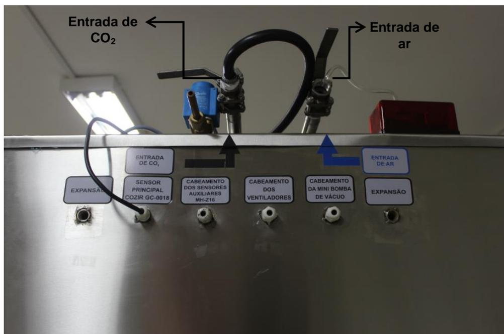
Figura 67: Vista traseira da câmara de carbonatação - Fonte: Autor (2015).
