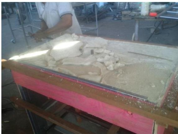
Figura 53: Retirada de excessos da espuma expansiva sólida - Fonte: Autor (2015).
