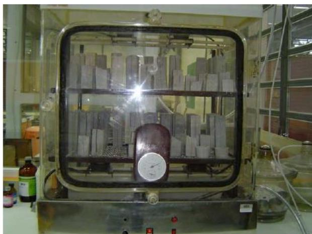
Figura 6: Vista frontal da câmara de carbonatação saturada - Fonte: Pauletti (2004).
