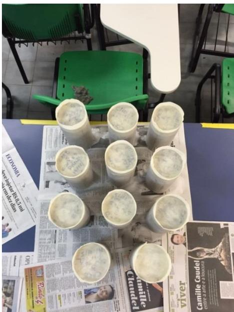
Figura 115: Corpos de prova selados com cera de parafina aguardando inserção na câmara de carbonatação - Fonte: Autor (2015).
