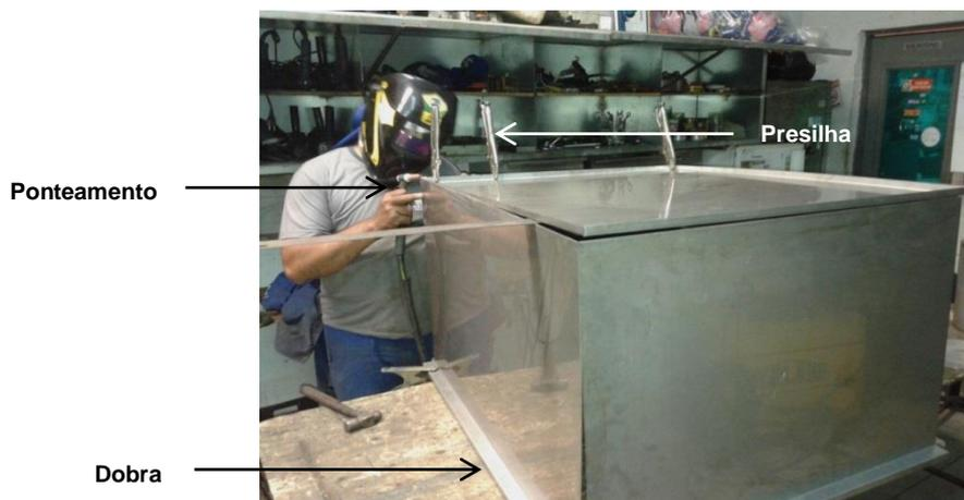
Figura 48: Ilustração das dobras e marcações do gabinete da câmara de carbonatação - Fonte: Autor (2015).
