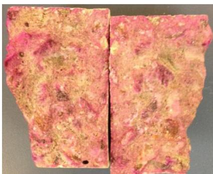
Figura 124: Exemplo de corpo de prova não carbonatado aos 7 dias de exposição-
