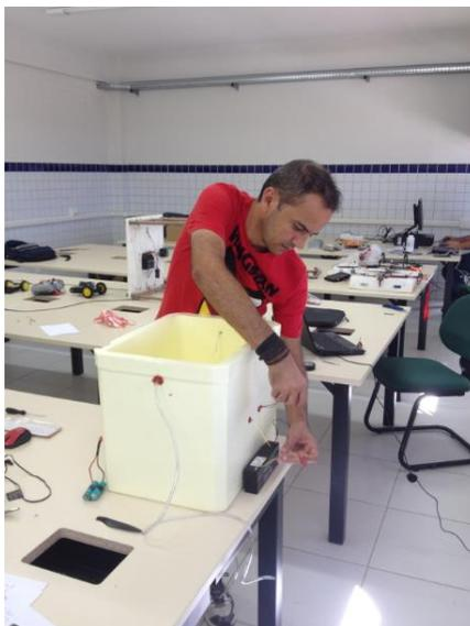
Figura 1: Caixa de isopor utilizada para o primeiro teste real com a utilização de CO<sub>2</sub> – modelo experimental - Fonte: Autor (2015).
