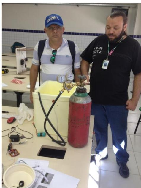
Figura 5: Injeção de  $\text{CO}_2$  no interior da caixa de isopor – modelo experimental - Fonte: Autor (2015).
