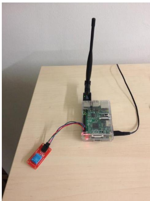
Figura 27: Dispositivo de micro controle de temperatura – modelo experimental -
