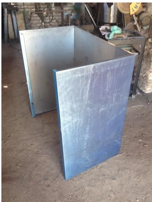
Figura 51: Ilustração do invólucro da câmara de carbonatação - Fonte: Autor (2015).
