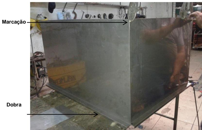
Figura 47: Ilustração das dobras e marcações do gabinete da câmara de carbonatação - Fonte: Autor (2015).
