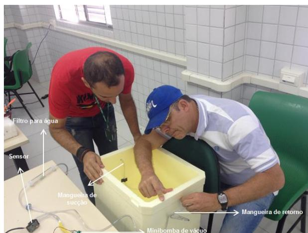
Figura 2: Instalação dos dispositivos avaliadores de CO<sub>2</sub> – modelo experimental - Fonte: Autor (2015).
