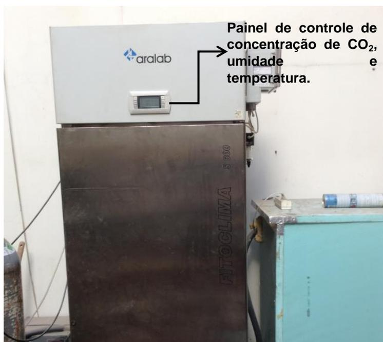
Figura 19: Câmara de carbonatação acelerada do laboratório de materiais de construção da UMinho-Portugal - Fonte: Autor (2015).
