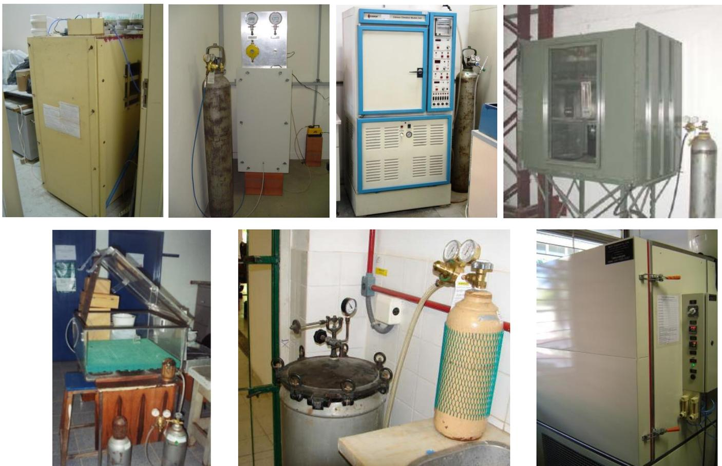
Figura 13: Câmaras de carbonatação utilizadas no programa interlaboratorial -
