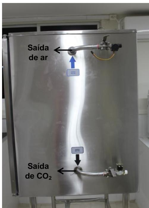
Figura 65: Vista lateral direita da câmara de carbonatação - Fonte: Autor (2015).
