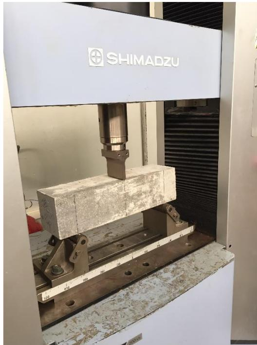
A velocidade do carregamento no ensaio foi de 226,6 Kgf/min, que gera no corpo de prova uma tensão de aproximadamente 1,0 MPa/min.
