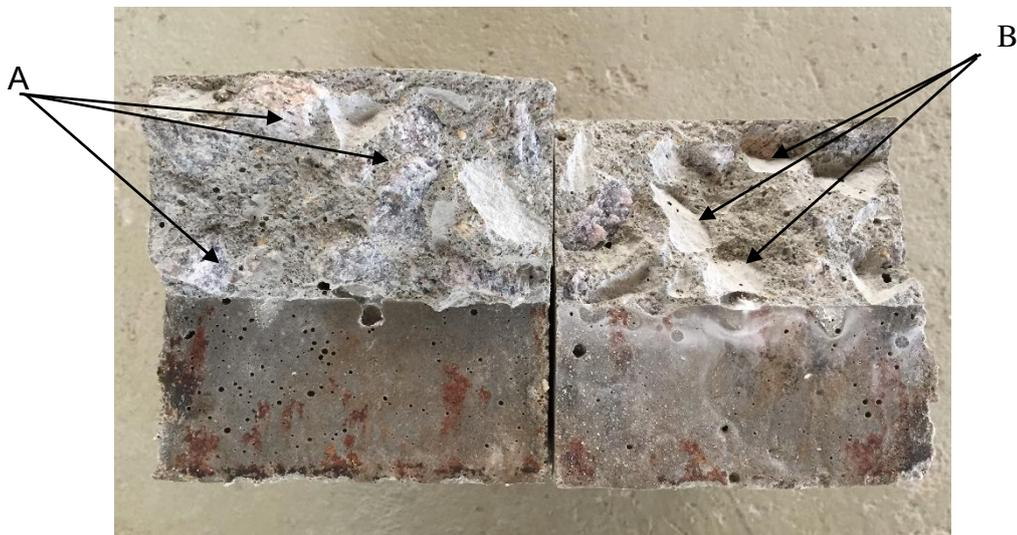
Os destaques A e B, demonstram a face exposta do agregado graúdo e uma depressão no lado oposto da superfície de fratura, respectivamente, provocada pela propagação da trinca principal (entalhe) através da zona de transição.
