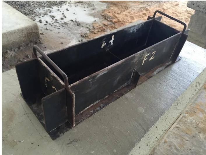
Como todas as peças para redução do tamanho dos corpos de prova, bem como o “fundo falso” para execução do entalhe, não foram feitas de forma definitiva nas formas originais, ou seja, não foram soldadas nas mesmas, a continuidade do uso das formas com suas dimensões originais foi garantido, bem como adicionado a este duas outras possibilidades de uso: tamanho reduzido com e sem entalhe.
