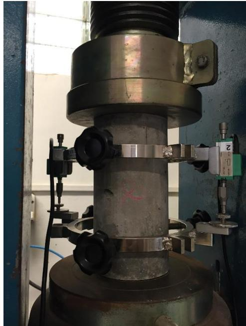
Um fator importante a ser levado em conta visando a boa execução e confiabilidade do ensaio, é que a diferença de deformação medida entre os LVDT's não ultrapasse o limite de 20%. Essa verificação é feita eletronicamente e informada ao usuário momento a momento do ensaio.
