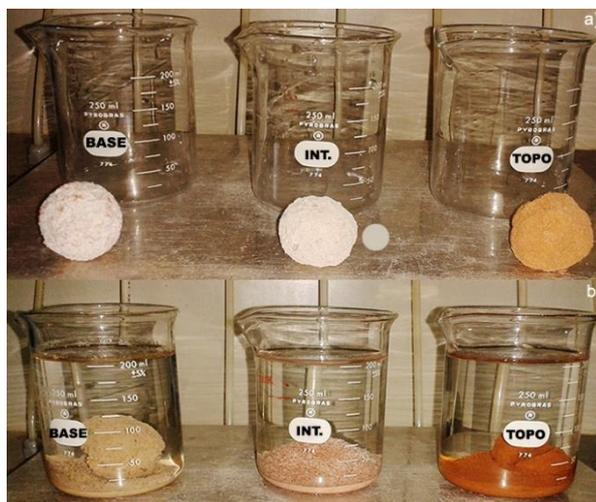
Figura 4.7 - Ensaio de Imersão Total (*Crumb Test*). a) Amostras antes da imersão. b) Amostras após a imersão.
