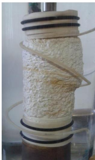
Figura 4.3 - Corpo de prova após etapa de cisalhamento
