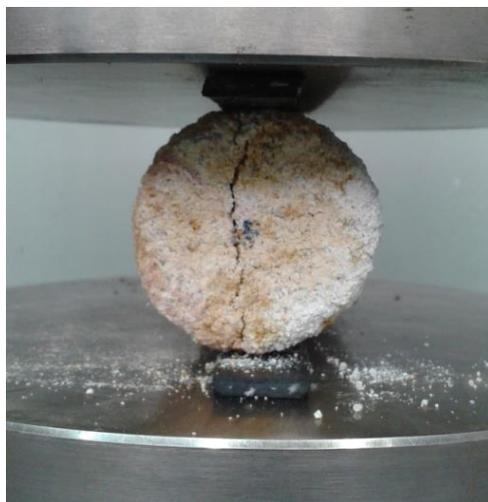
Figura 4.5 - Ensaio de Resistência à Compressão Diametral
