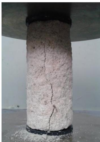
Figura 4.4 - Ensaio de Resistência à Compressão Simples
