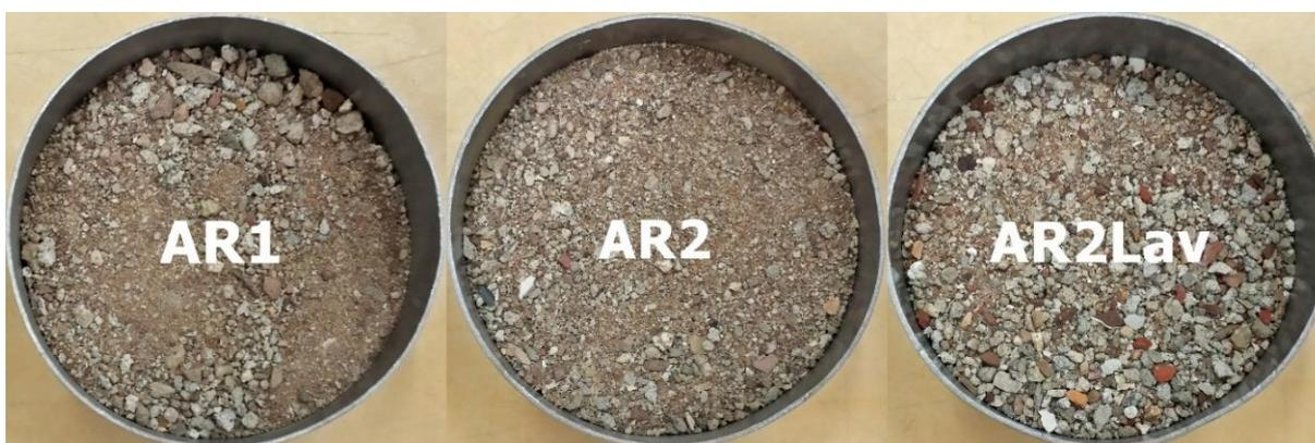
Figura 3.5 – Areias recicladas utilizadas na produção das argamassas
