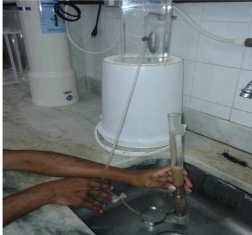
Figura 3 - Esquema da execução da retrolavagem dos FLA.
