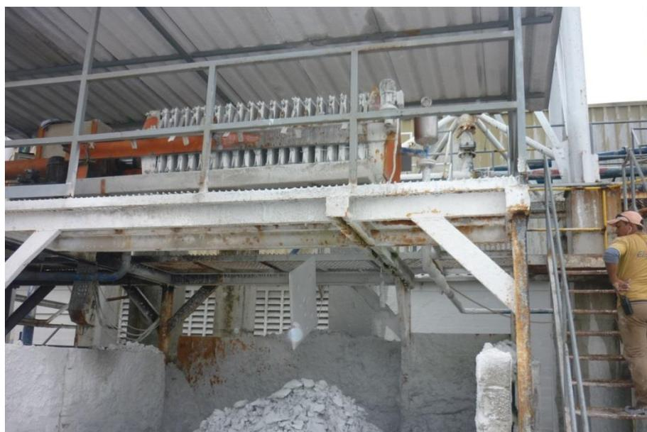
Figura 2.11 – Liberação em leira, pela prensa, de placa de resíduo úmido comprimido.
