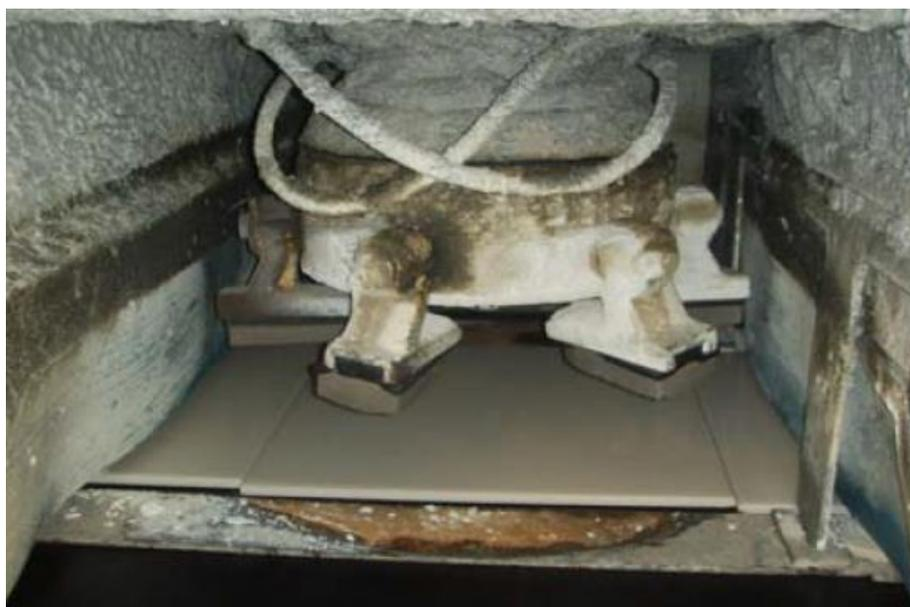
Figura 2.10 – Equipamento polidor com 6 cabeças polidoras (tijolos abrasivos).
