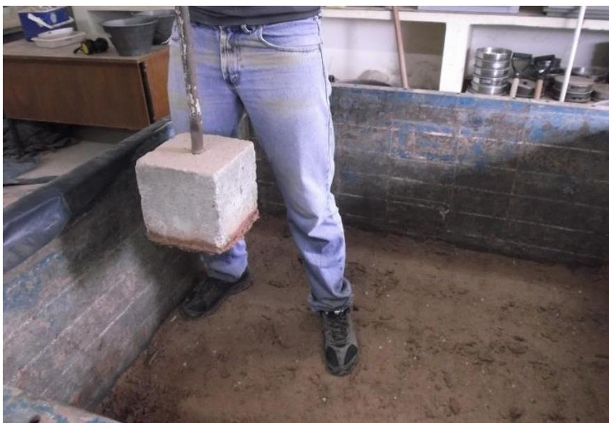
Figura 3.6 – Compactação da primeira camada de solo puro na caixa metálica.
