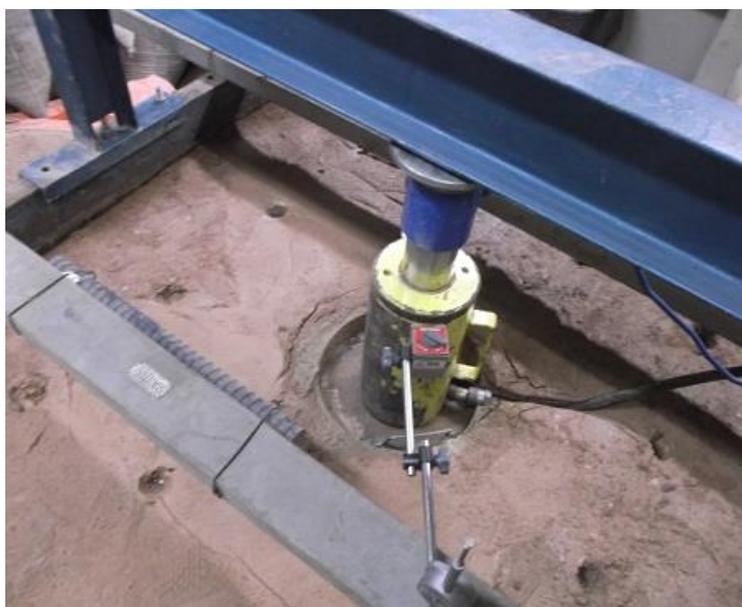
Figura 4.16 – Afundamento da placa no aterro compactado com solo puro.
