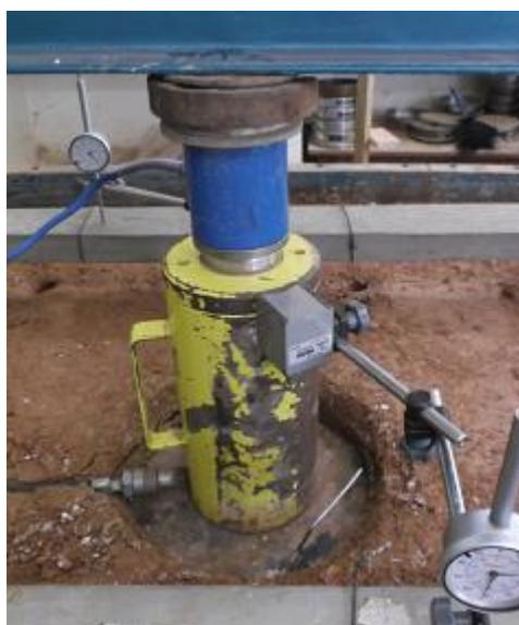
Figura 4.18 – Afundamento da placa no aterro compactado com Mistura de 5%.
