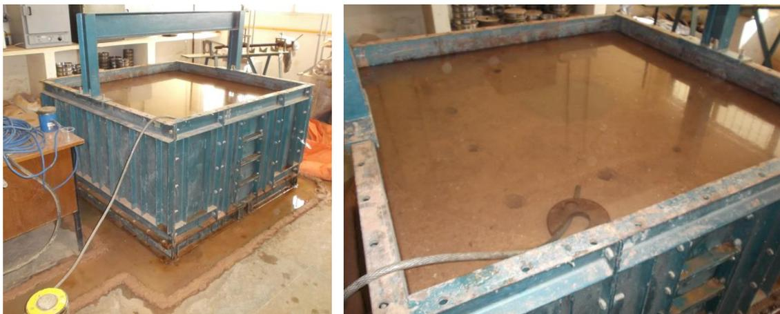
Figura 3.9 – Aterro inundado. Detalhe para a lâmina d'água e os furos verticais.
