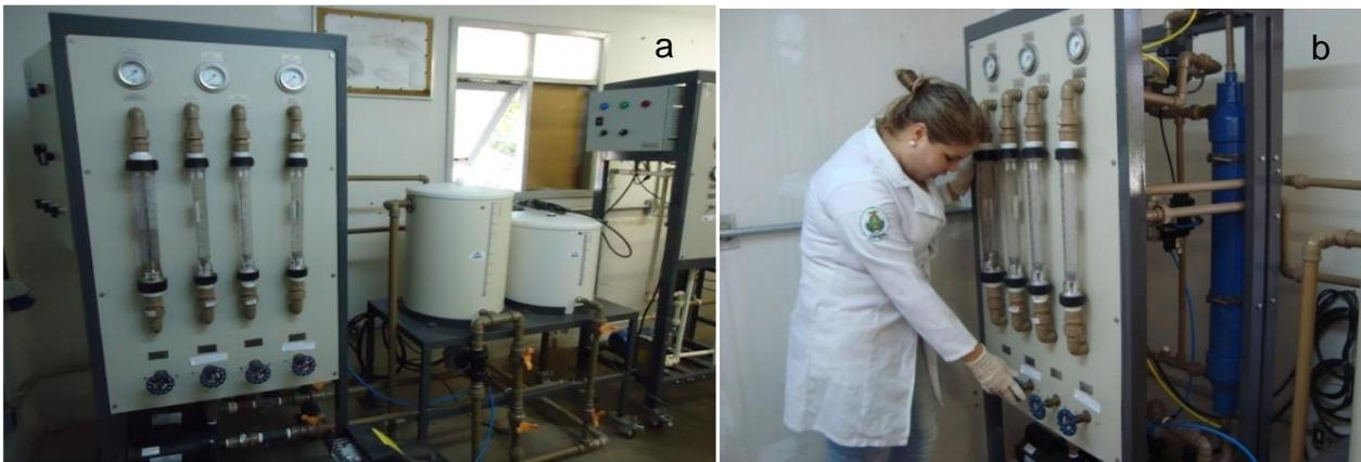
Figura 10. Equipamento de membrana em escala piloto utilizado na pesquisa (a), com detalhe para a membrana de UF acoplada no equipamento (b). Fonte: Silva (2014).
