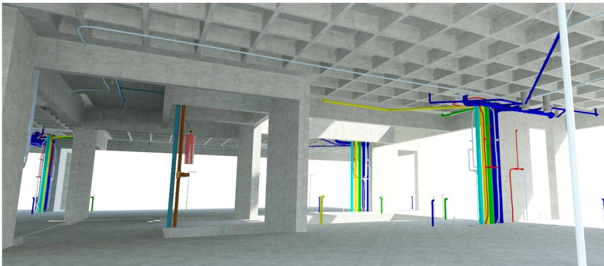
Figura 5.6: Definição do Tamanho do Lote de Produção e Transferência – Exemplo de Instalações Pavimento Tipo (Autor, 2014)
