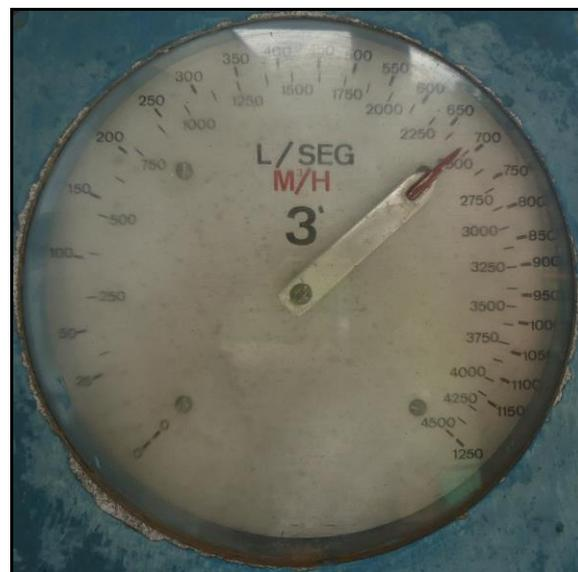
**Figura 3.17- Antigo medidor de vazão da Água Bruta de Extremoz**
