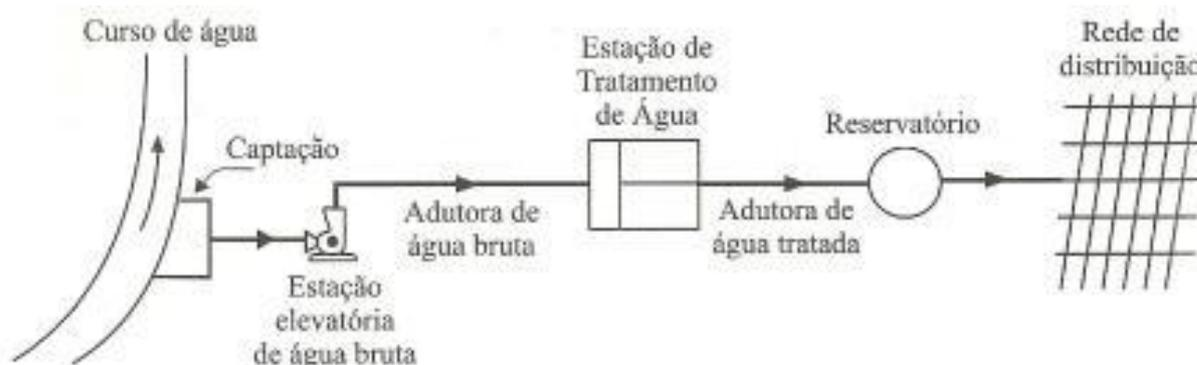
**Figura 2.1- Partes integrantes de um sistema de abastecimento de água**
