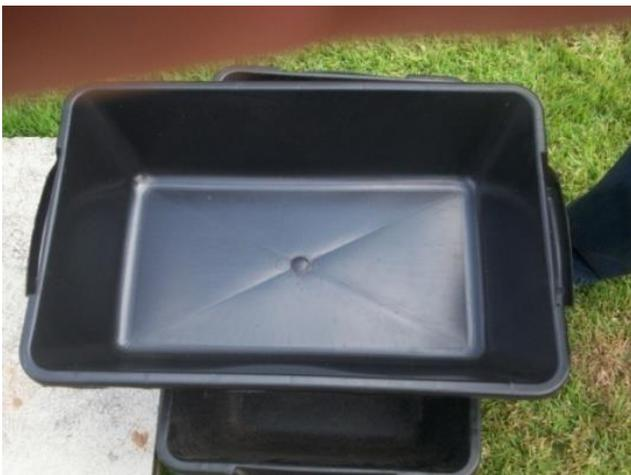
Figura 31: Bandeja utilizada para aumentar a área de captação dos coletores
