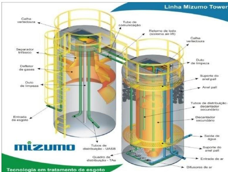
Figura 18: Desenhos esquemáticos do modelo de estação de tratamento de esgoto utilizada na UO-RNCE da PETROBRÁS.
