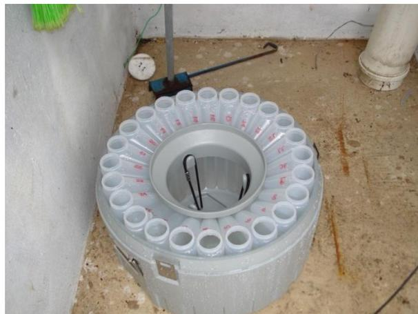
Figura 4.8 Garrafas coletoras do amostrador automático
