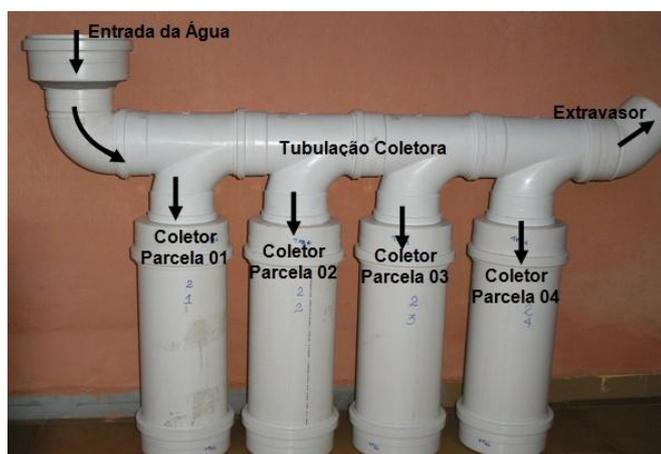
Figura 4.10 Amostrador composto e esquema de funcionamento
