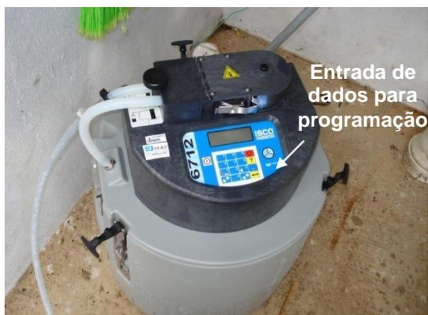
Figura 4.6 Amostrador automático ISCO 6712
