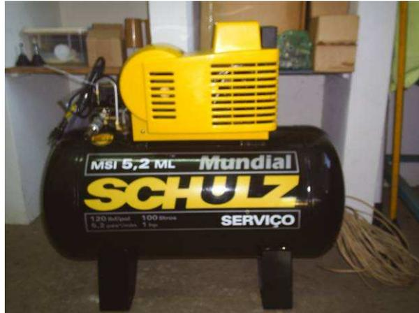
**Figura 3.7: Compressor utilizado para fornecimento de ar.**
