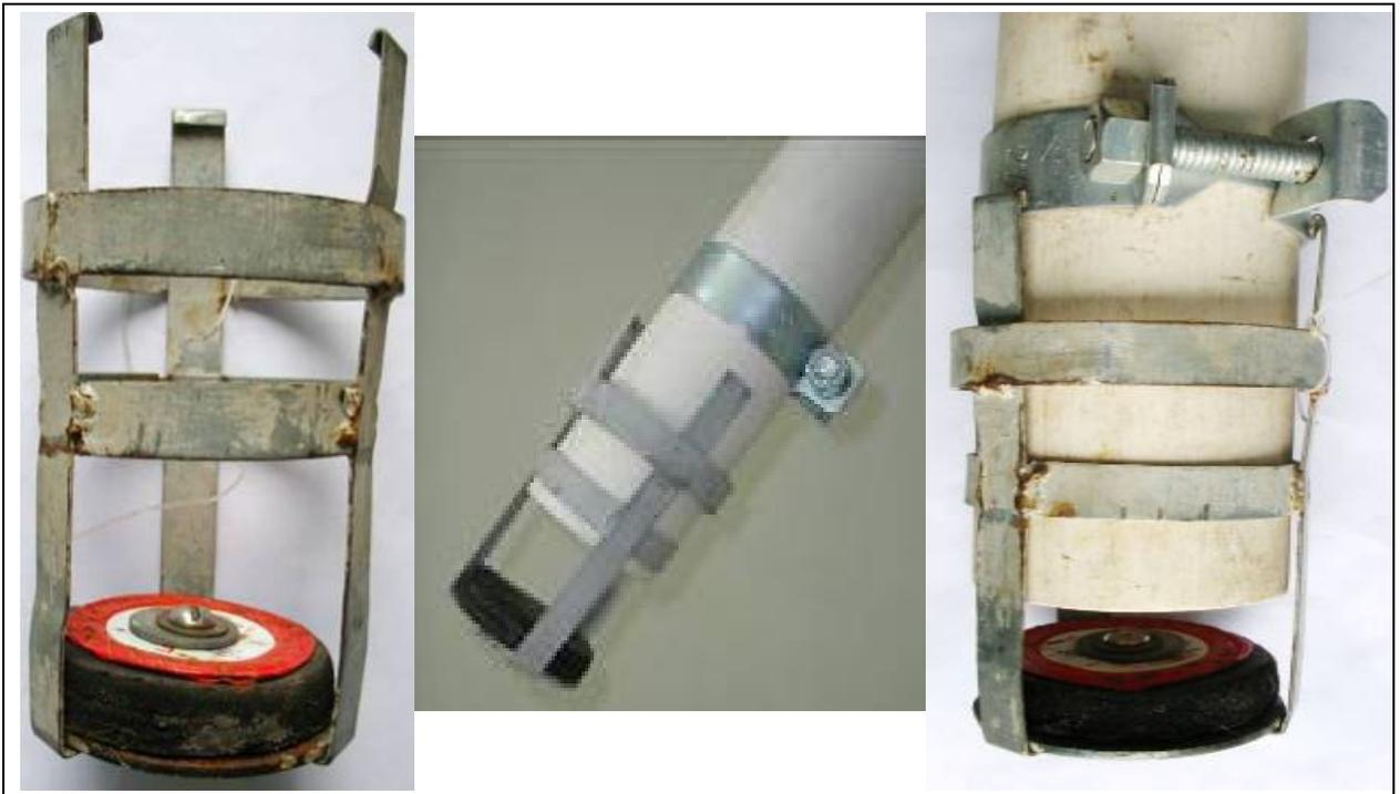
**Figura 15: Segunda e definitiva tampa na extremidade do amostrador contendo três asas de ferro com anel de borracha parafusado a base da tampa.**
