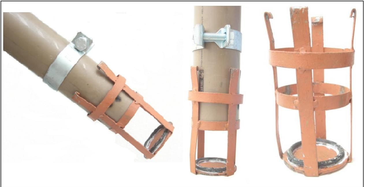
**Figura 14: Primeira tampa desenvolvida para o amostrador contendo 4 asas de ferro e com anel de borracha colado no fundo da tampa.**
