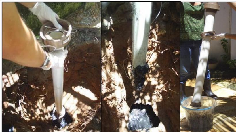
**Figura 18: Etapas da utilização do amostrador de coluna em uma câmara de tanque séptico.**
