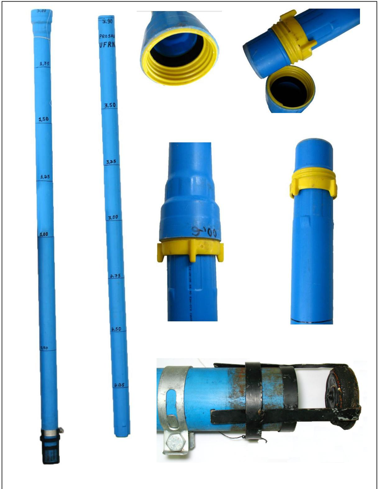
Figura 17: Amostrador de coluna feito com tubulações para irrigação.
