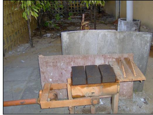
Figura 5.11 – Prensa manual para moldagem dos tijolos maciços.
