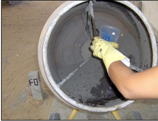
Figura 5.10 – Betoneira para mistura da massa cerâmica.
