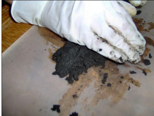
Figura 6.1 – Ensaio de plasticidade do lodo de esgoto.
