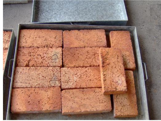
Figura 5.13– Tijolos com 20% de lodo depois da queima.
