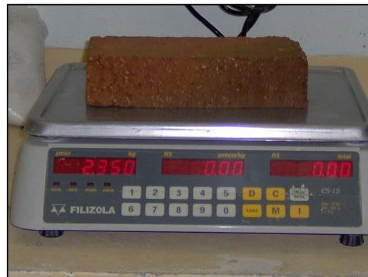
Figura 5.15 – Pesagem de tijolo úmido.
