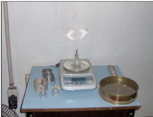
Figura 5.7 – Pesagem do picnômetro vazio.
