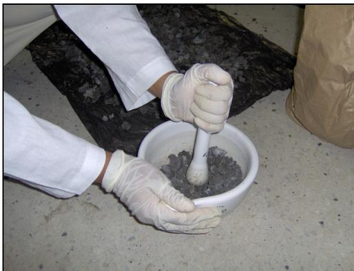
Figura 5.3 – Destorroamento das argilas.
