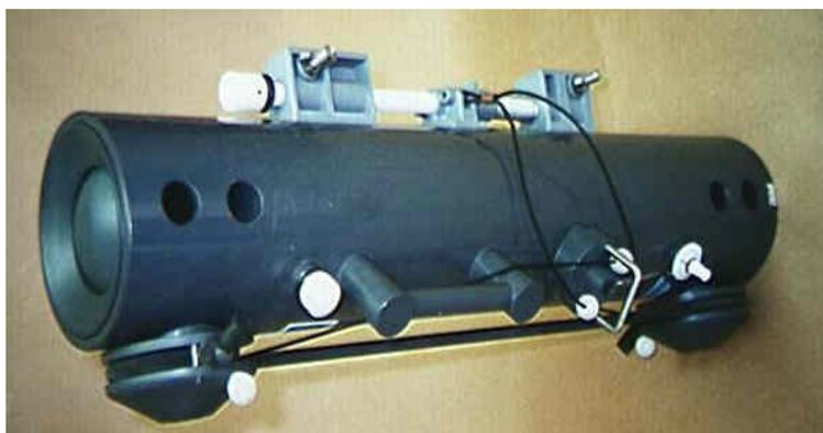
Figura 12: Amostrador de água Go-Flo modelo 1080.
