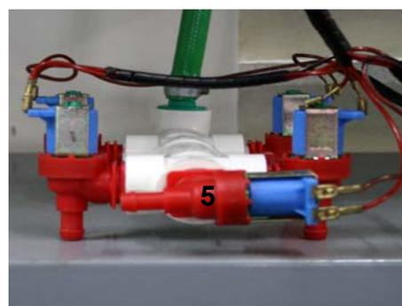
Figura 38: Vista frontal da tubulação de distribuição.
