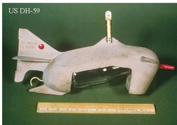
Figura 10: Coletor de amostra US DH-59.
