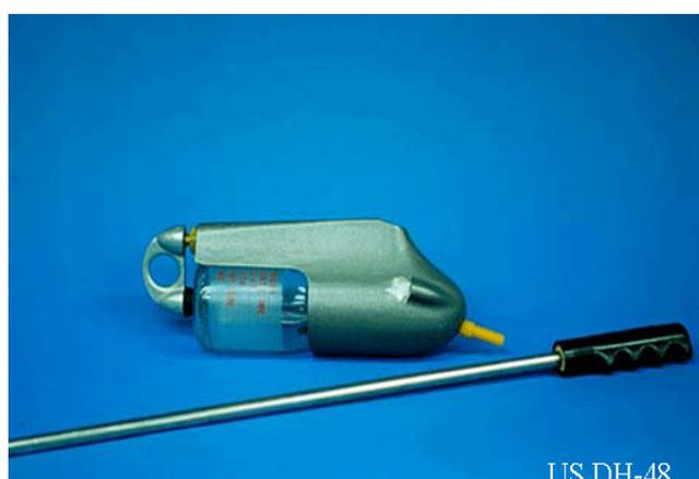
Figura 9: Coletor de amostra US DH-48.
