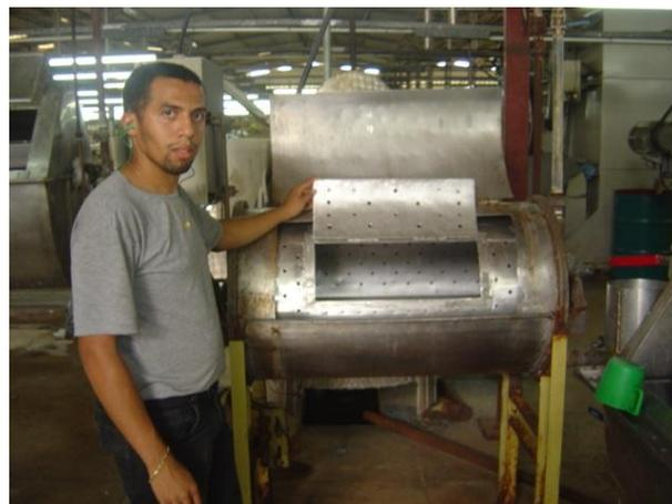
**Figura 5. Máquina de amostra de lavagem.**
