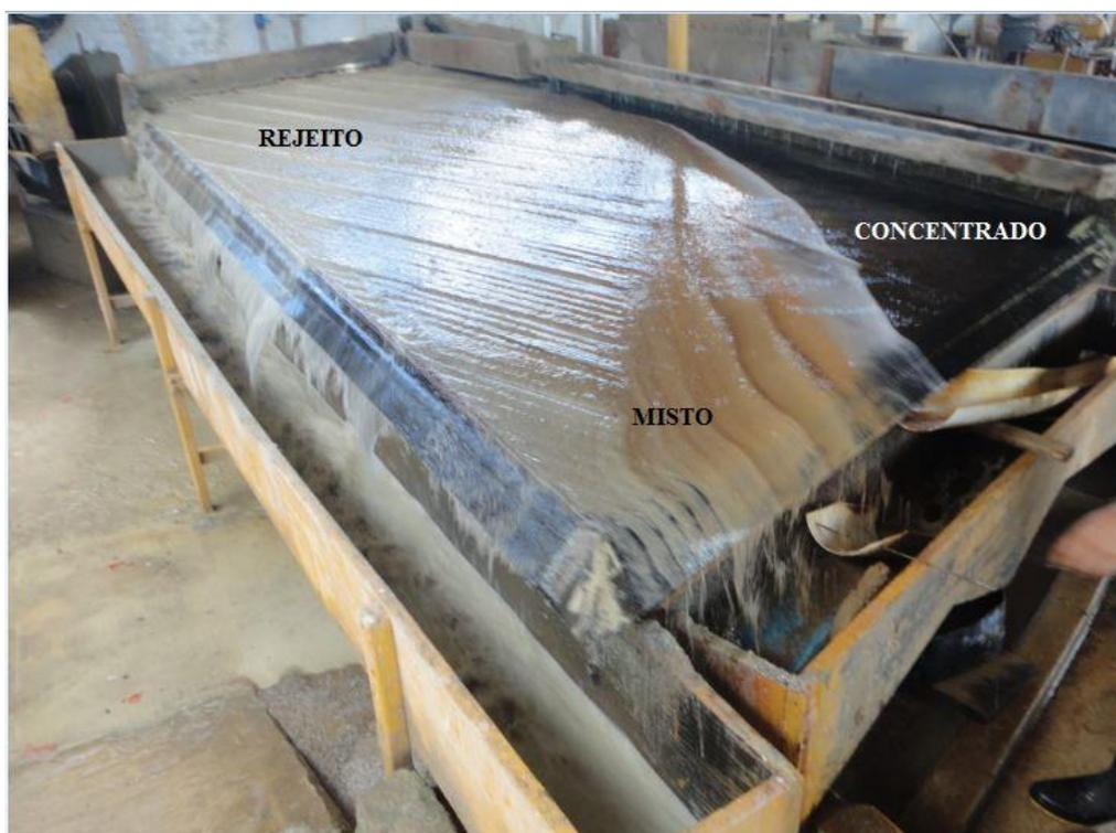
Fotografia 2 – Mesa vibratória com detalhe para o rejeito e o concentrado fino da scheelita, mina Barra Verde, Currais Novos-RN.
