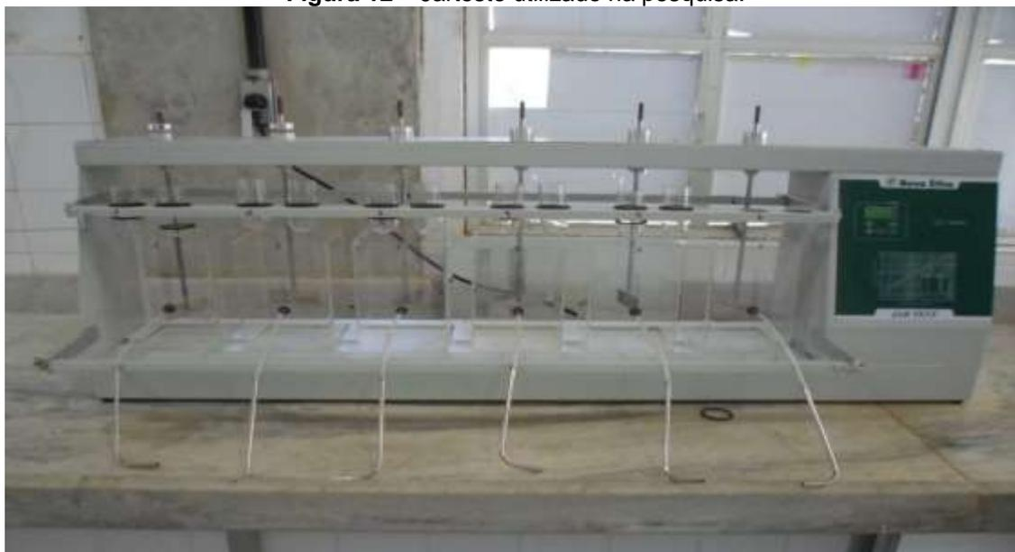
Para cada reator há uma palheta metálica interligada ao misturador com mostrador digital com faixa de rotação que varia de 30 a 600 rpm (rotações por minuto), que correspondem a gradientes de velocidade de  $15 \text{ s}^{-1}$  a  $1486 \text{ s}^{-1}$ .
