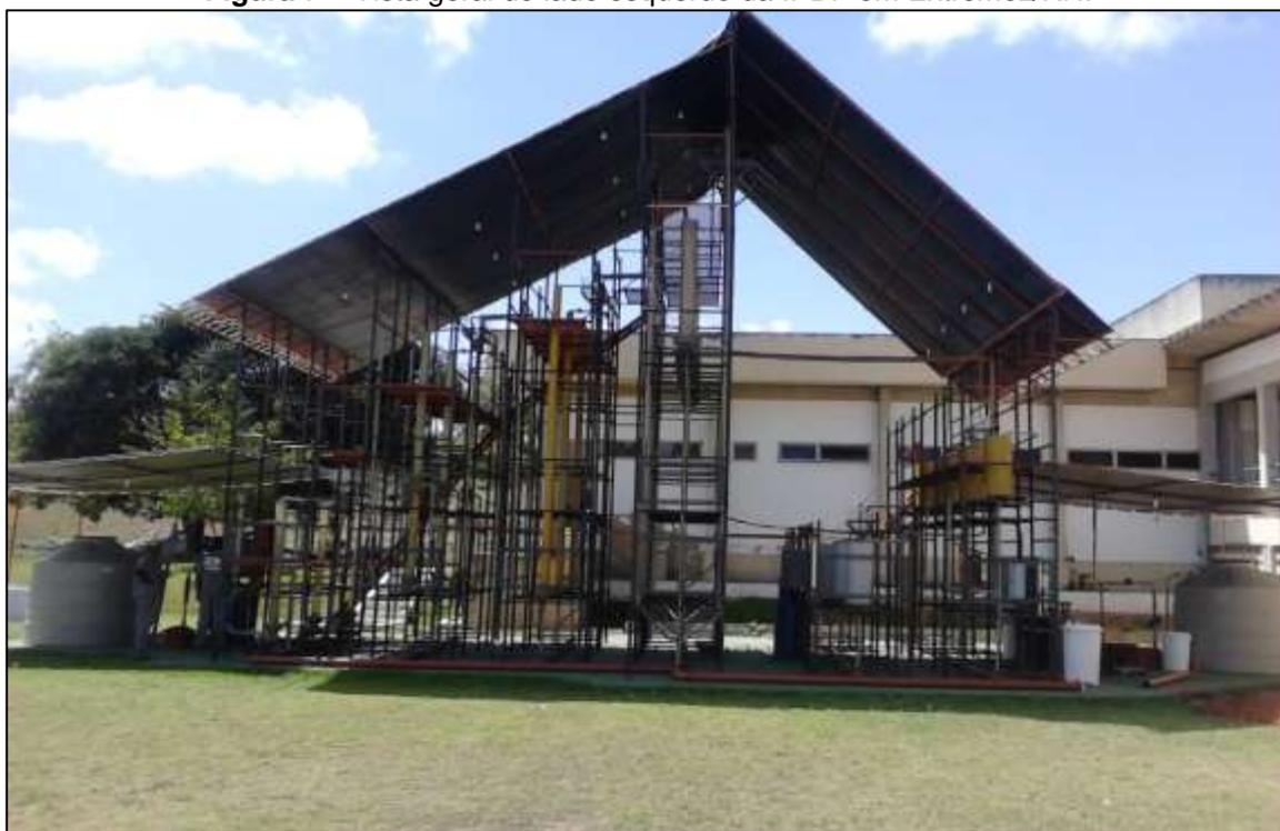
Os filtros FAP e FRDA têm diâmetros externos de 200 mm e 100 mm, respectivamente e foram construídos em fibra de vidro revestida com resina de poliéster, semitransparente.
