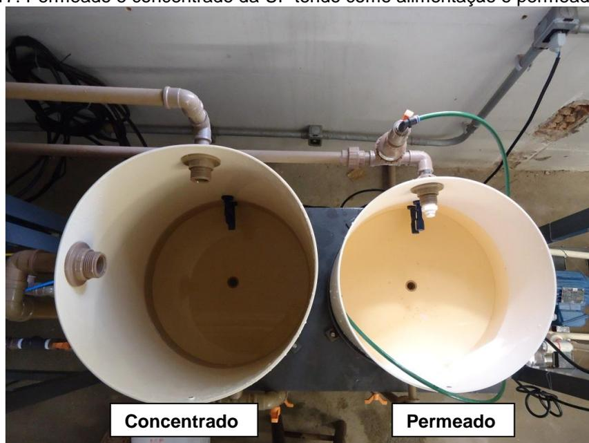
Figura 18: Permeado e concentrado da NF tendo como alimentação o permeado da UF.
