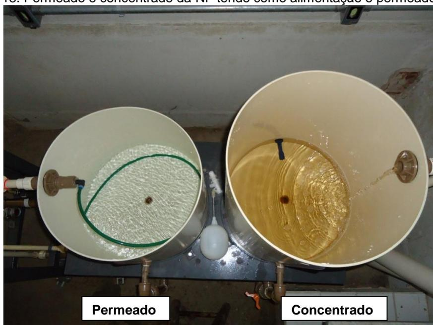
Figura 19: Permeado e concentrado da OI, tendo como alimentação o permeado da NF.
