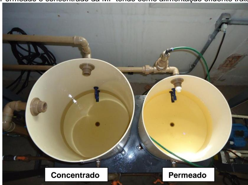
Figura 17: Permeado e concentrado da UF tendo como alimentação o permeado da MF.
