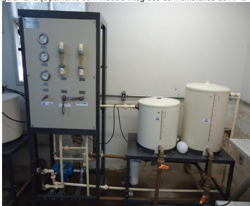
O líquido era inserido no módulo de membranas sob pressão, através de bombeamento, onde era separado em duas correntes: concentrado, que era recirculado para o tanque de alimentação; e permeado, que era direcionado para o tanque de armazenamento.
