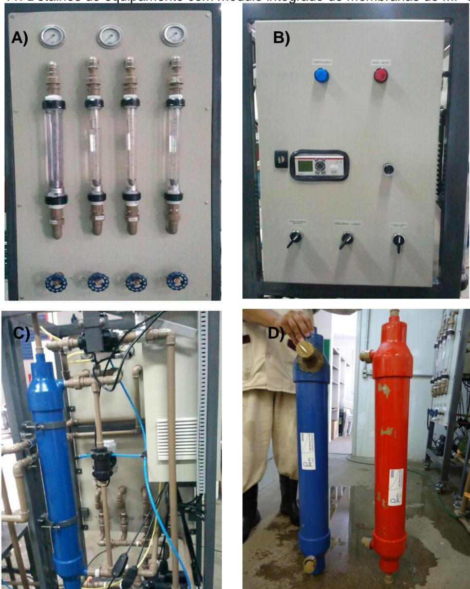
A): Painel hidráulico; B): Painel elétrico; C) Parte de trás do módulo de MF e UF; D) Membrana de MF (direita) e membrana de UF (esquerda).
