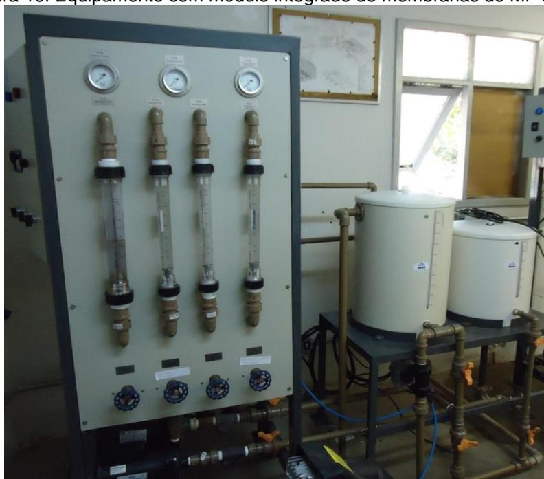
Os principais componentes do equipamento com módulo integrado de membranas de MF e UF:
