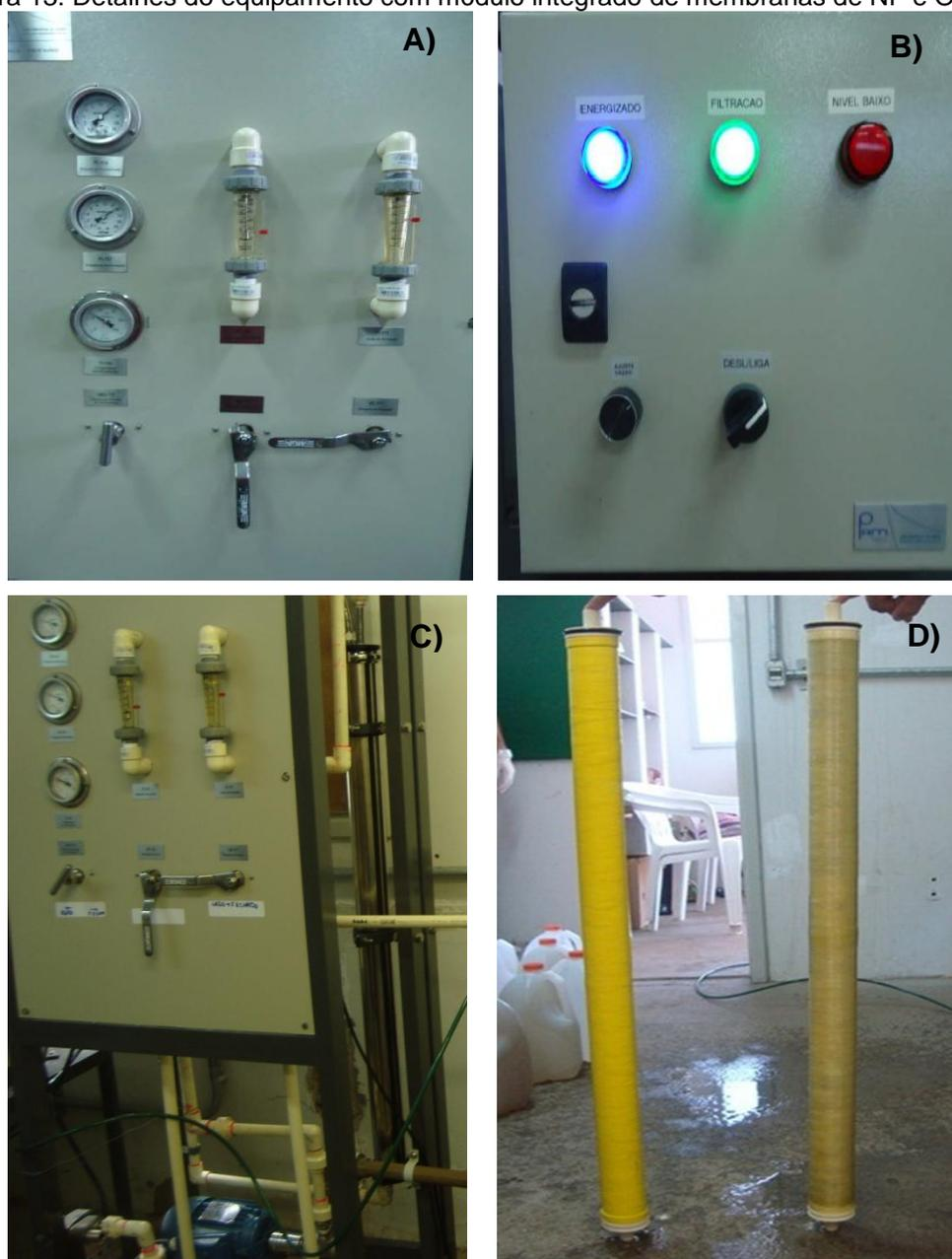
A): Painel hidráulico; B): Painel elétrico; C) Módulo com vaso em aço-inox; D) Membrana de nanofiltração (direita) e membrana de osmose inversa (esquerda);
