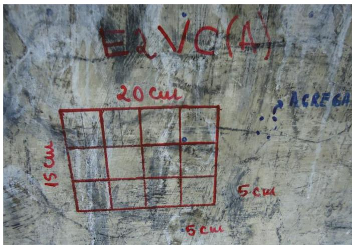
Figura 35: Malha para ensaio de esclerometria – Fonte: Autor (2015).
