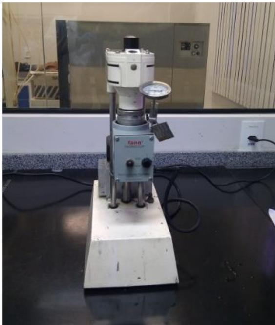
Para a leitura do gel inicial, a pasta foi mantida a 300 RPM de rotação por um minuto; em seguida em repouso por 10 segundos; e, por fim, colocada sob rotação de 3 RPM, momento no qual foi feita a leitura de deflexão máxima. Para a leitura do gel final, o viscosímetro permaneceu desligado por 10 minutos e, em seguida, foi ligado com 3 RPM de rotação, momento no qual foi verificada a deflexão máxima.
