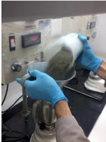
Após a mistura, a homogeneização foi realizada em um Consistômetro Atmosférico da marca Chandler Engineering modelo 1200 (Figura 9), durante 20 minutos, sob rotação de 150 RPM, a uma temperatura de 91°F, seguindo a temperatura estática proposta.
