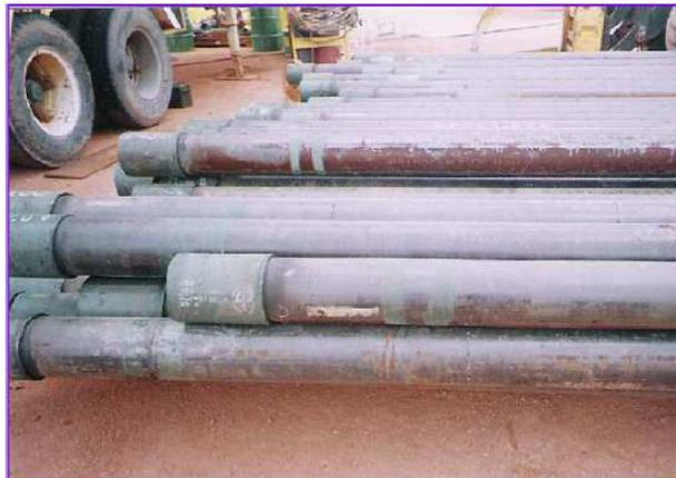
Figura 1 – Tubos de revestimento (Fonte: Galvão; Da Mata, 2012)
