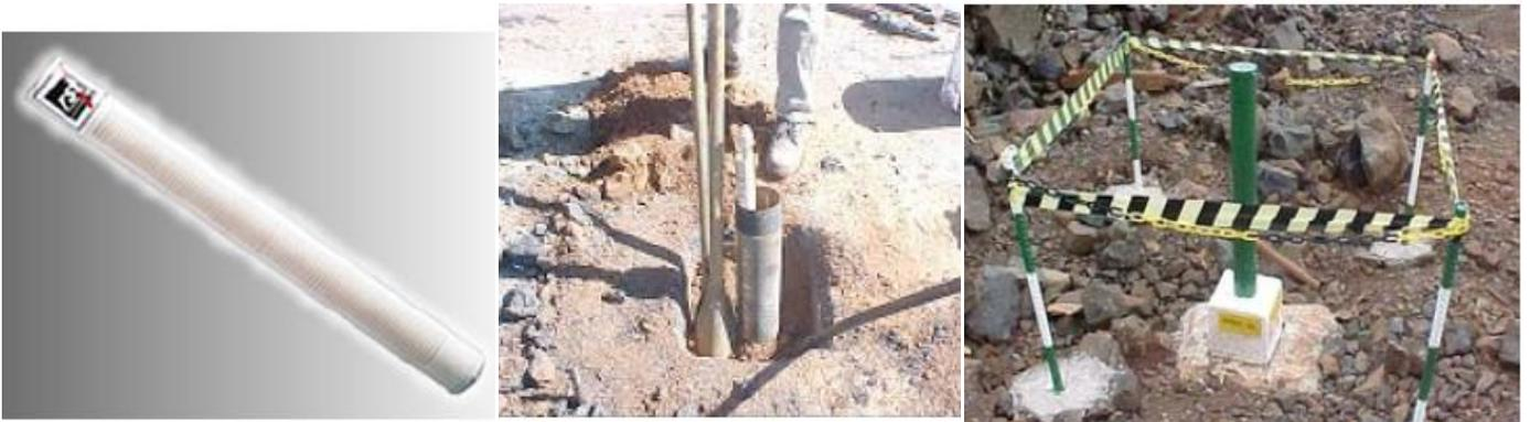
Figura 2.14: Piezômetro Casagrande de tubo aberto
