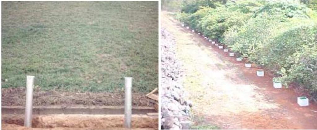
Figura 2.13: Medidores de nível d'água
